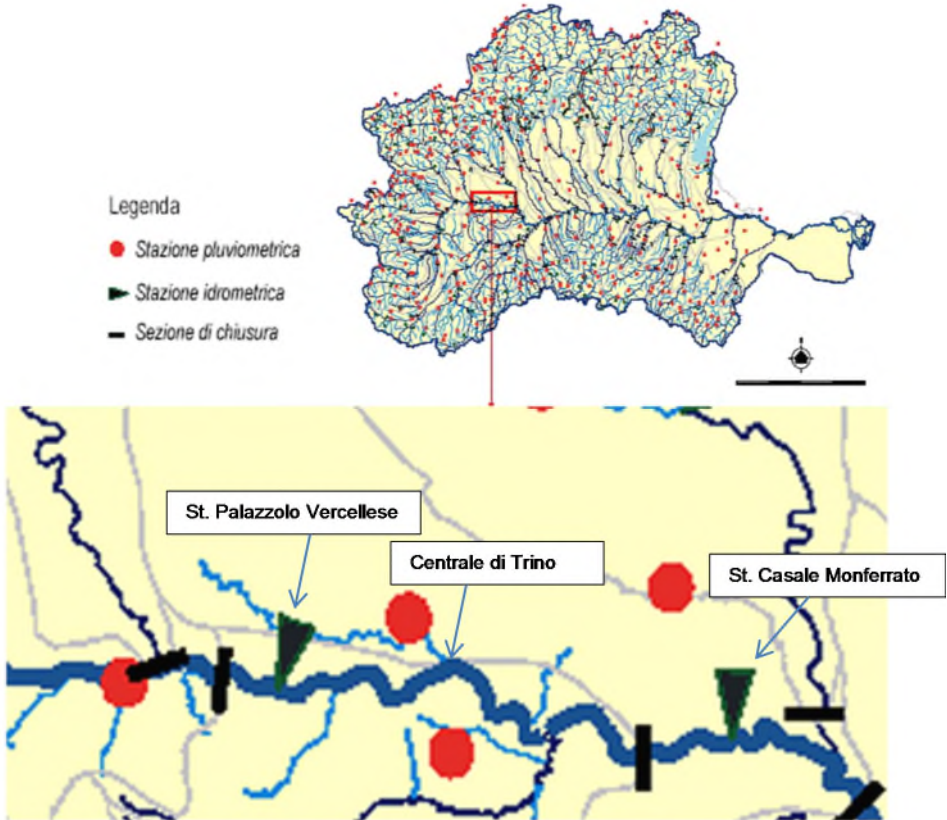
Figura 5-7 - Stazioni pluviometriche e idrometriche per l’area di interesse (Autorità di Bacino del Po)
