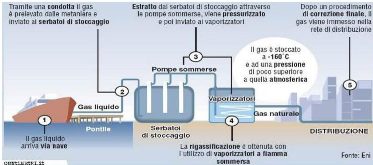
FIGURA 10-4 – SCHEMA FUNZIONALE DI RIGASSIFICATORE
