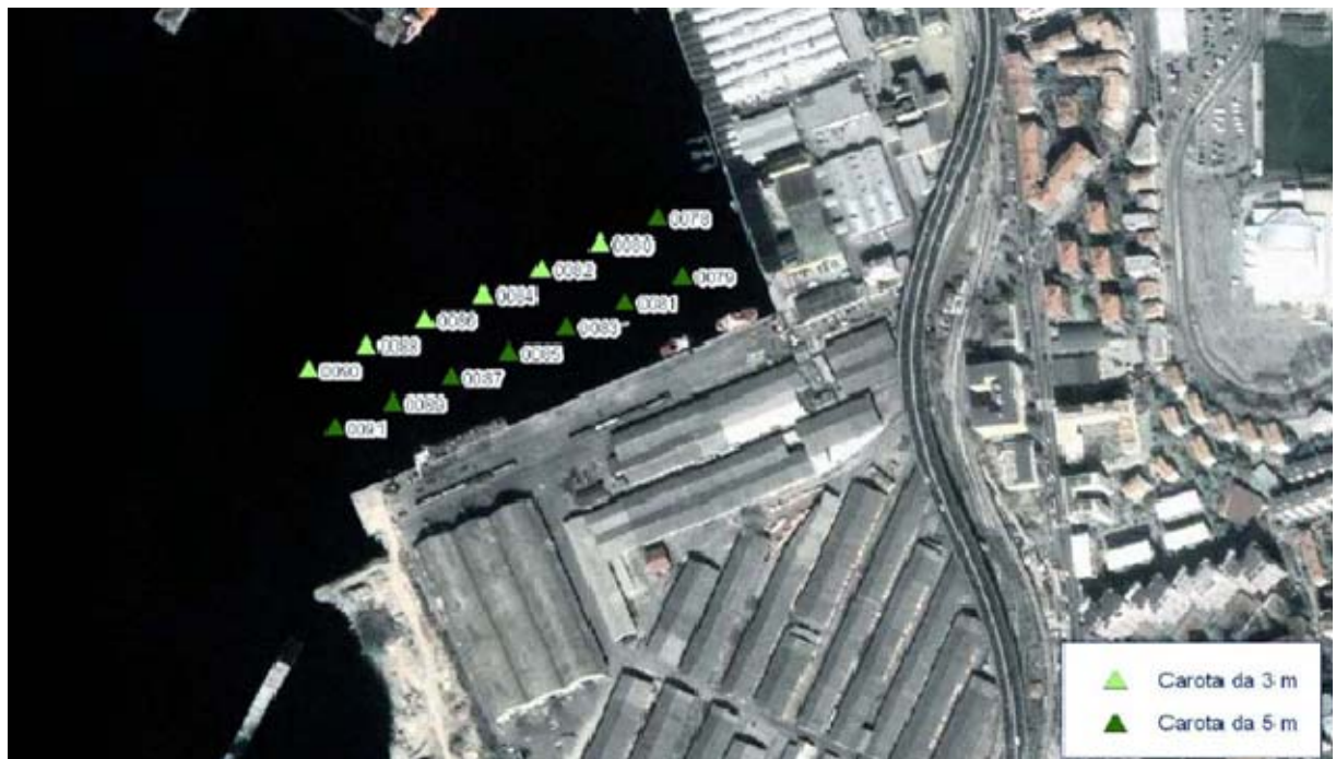
FIGURA 7-35 – SONDAGGI ESEGUITI NELL'AREA ANTISTANTE LO SCALO LEGNAMI.
