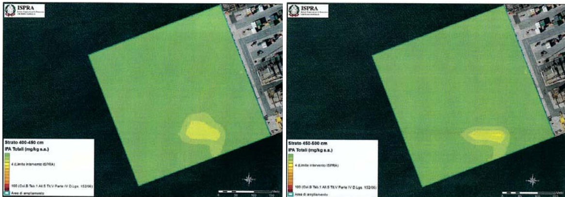
FIGURA 7-54 –ELABORAZIONE SPAZIALE DELLE CONCENTRAZIONI DI IPA NELLO STRATO 400-450 CM E 450-500 CM
