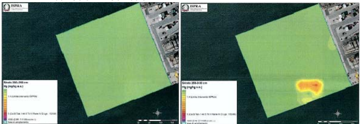
FIGURA 7-47 –ELABORAZIONE SPAZIALE DELLE CONCENTRAZIONI DI HG NELLO STRATO 200-250 CM E 250-300 CM
