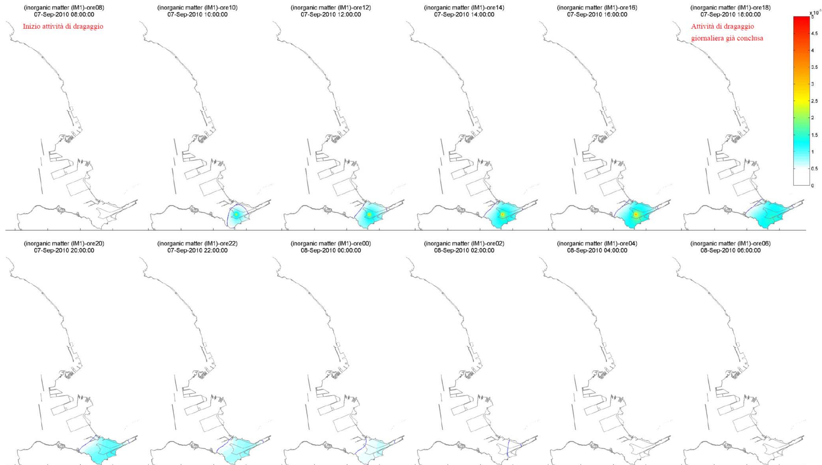
FIGURA 7-69 – PUNTO DI RILASCIO P1 -DISTRIBUZIONE DELLA CONCENTRAZIONE DI SOLIDI SOSPESI (G/M 3 ) PER LO SCENARIO CON LA MAREA MEDIA E VENTO DI BORA.
