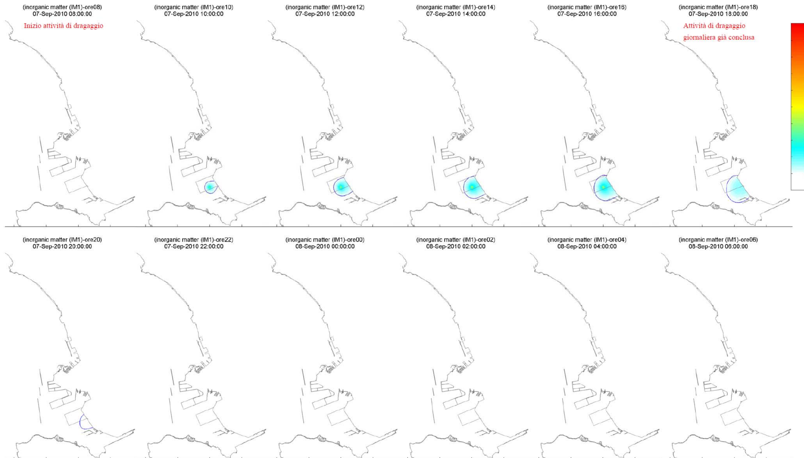
FIGURA 7-70– PUNTO DI RILASCIO P2 -DISTRIBUZIONE DELLA CONCENTRAZIONE DI SOLIDI SOSPESI (G/M 3 ) PER LO SCENARIO CON LA MAREA MEDIA E VENTO DI BORA.
