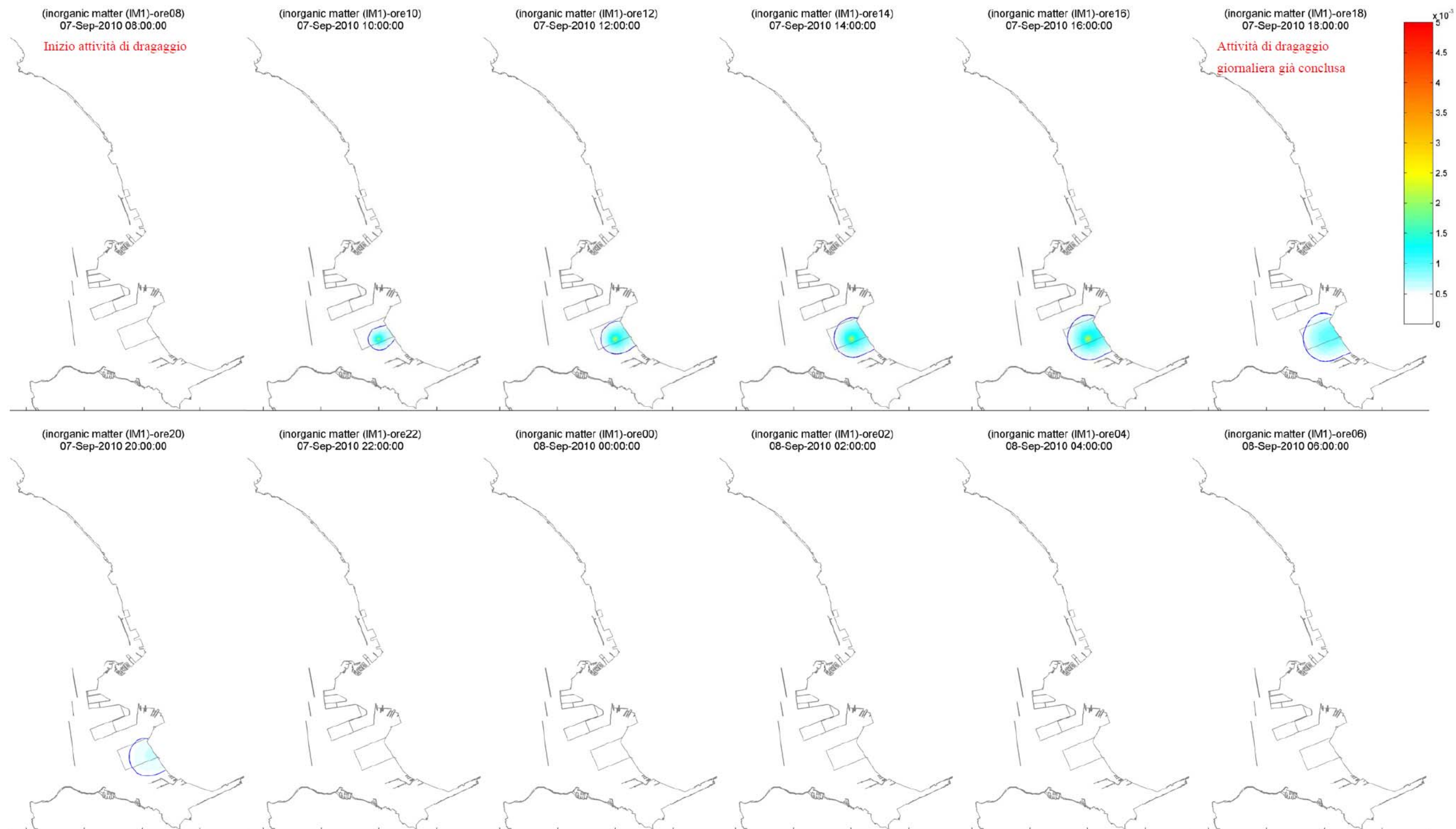
FIGURA 7-67– PUNTO DI RILASCIO P2 -DISTRIBUZIONE DELLA CONCENTRAZIONE DI SOLIDI SOSPESI (G/M 3 ) PER LO SCENARIO CON LA MAREA MEDIA E ASSENZA DI VENTO.
