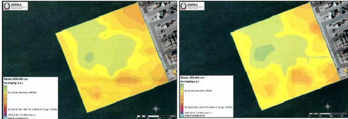
FIGURA 7-43 –ELABORAZIONE SPAZIALE DELLE CONCENTRAZIONI DI AS NELLO STRATO 300-350 CM E 350-400 CM
