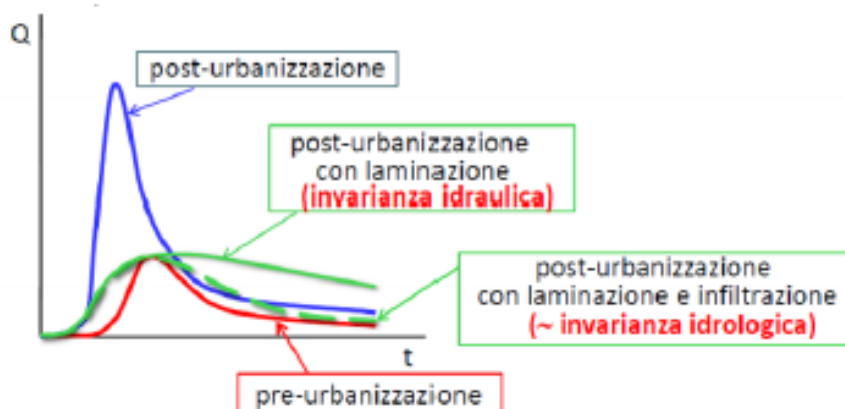
Figura 9-3 - Rappresentazione schematica del concetto di invarianza idraulica (da "Criteri e metodi per il rispetto del principio dell'invarianza idraulica ed idrologica Varese" - Geol. Marco Cinotti - Ing. Alessandro Balbo - Ing. Giacomo Galimberti)
