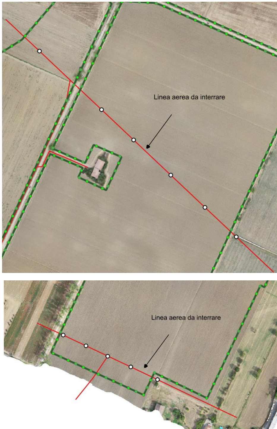
Figura 17 - Linee elettriche aeree esistenti da interrare
