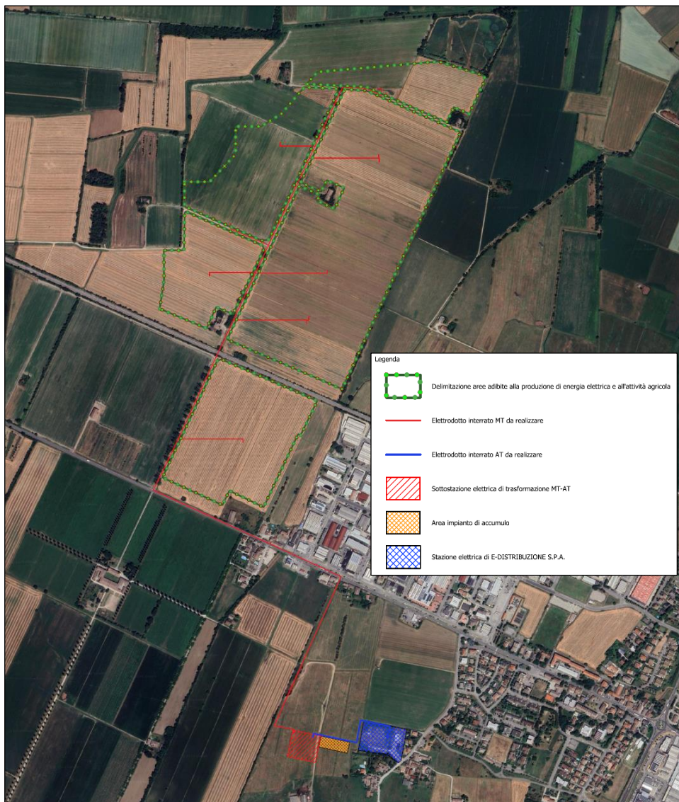
Figura 1 - Percorso dell'elettrodotto interrato da realizzare
