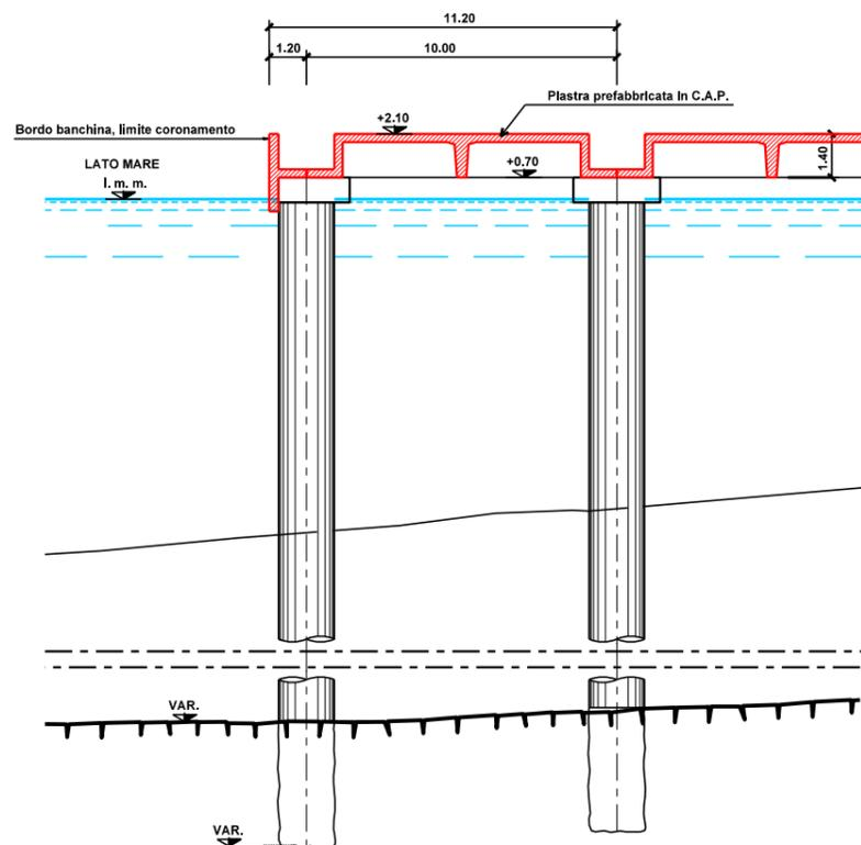
SEZIONE TIPO BANCHINA CON PALI IN C.A.
