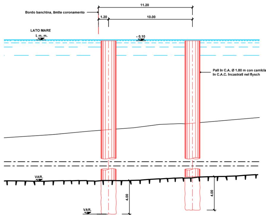
SEZIONE TIPO BANCHINA CON PALI IN C.A.
