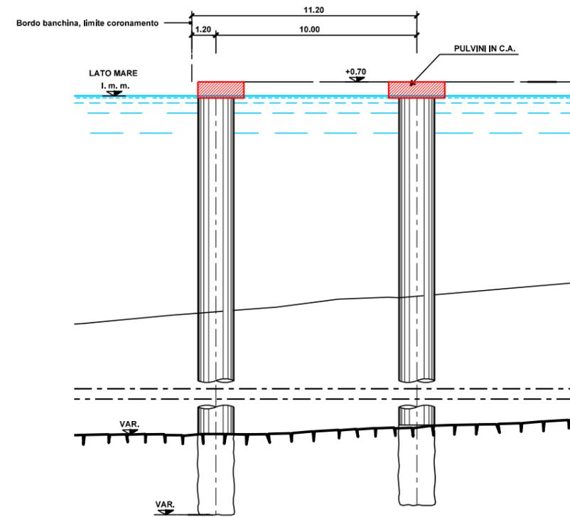
SEZIONE TIPO BANCHINA CON PALI IN C.A.
