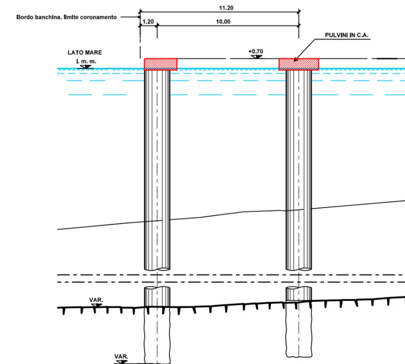
SEZIONE TIPO BANCHINA CON PALI IN C.A.
