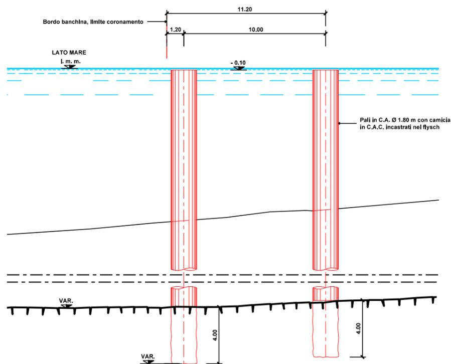
SEZIONE TIPO BANCHINA CON PALI IN C.A.
