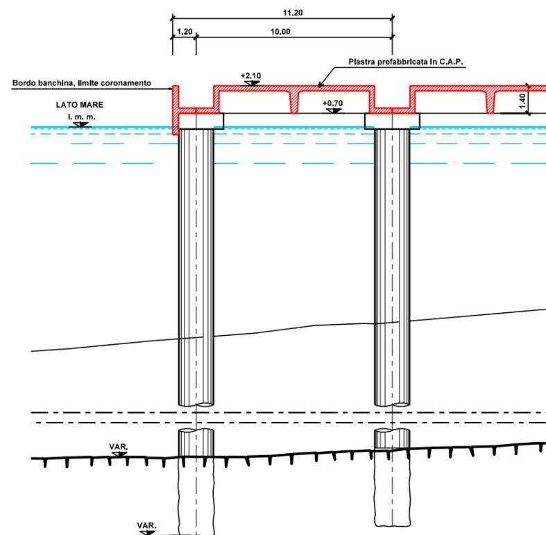
SEZIONE TIPO BANCHINA CON PALI IN C.A.
