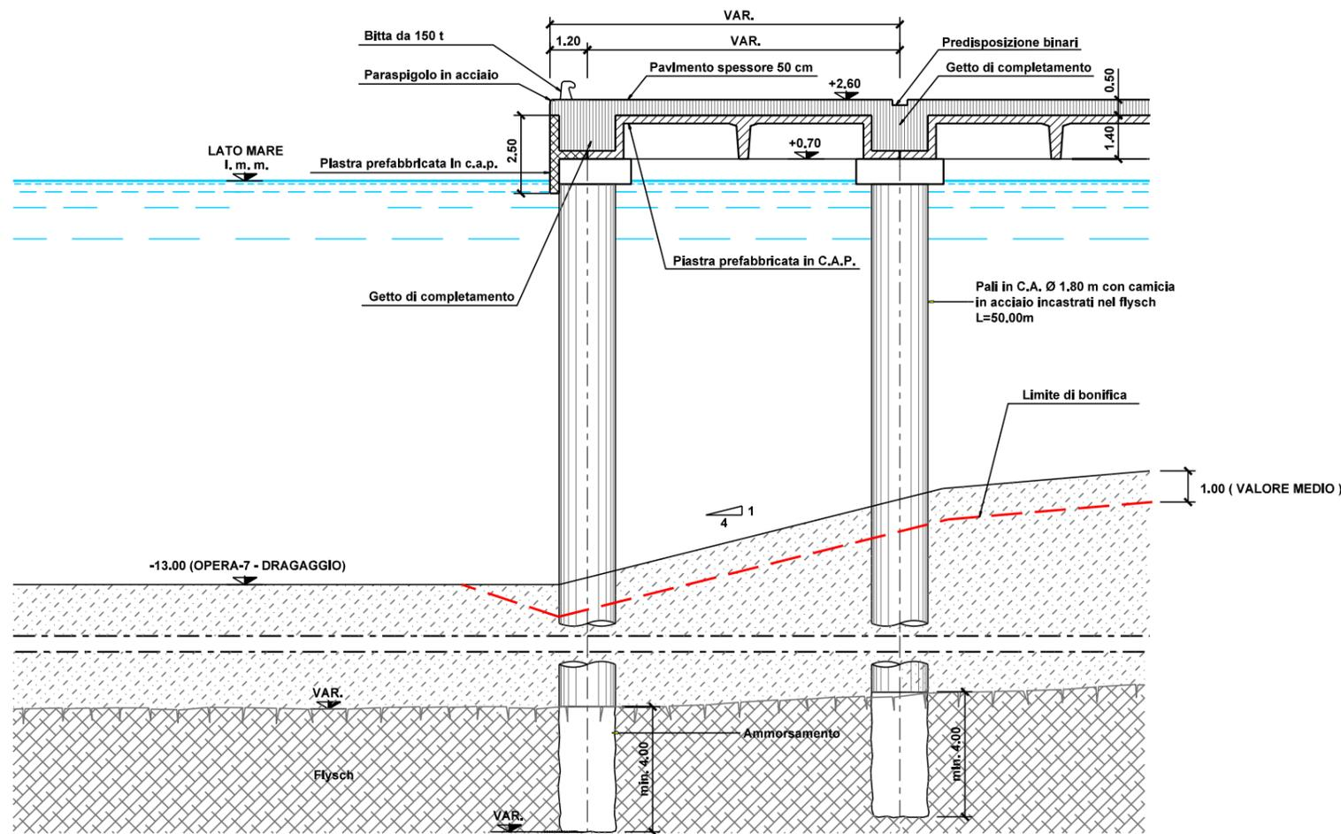
N.B. QUALORA IL DRAGAGGIO DOVESSE INTERESSARE STRUTTURE ESISTENTI SI DOVRA' PROVVEDERE ALLA LORO VERIFICA A STABILITA' O AL LORO CONSOLIDAMENTO CON UN PALANCOLATO DI PROTEZIONE
