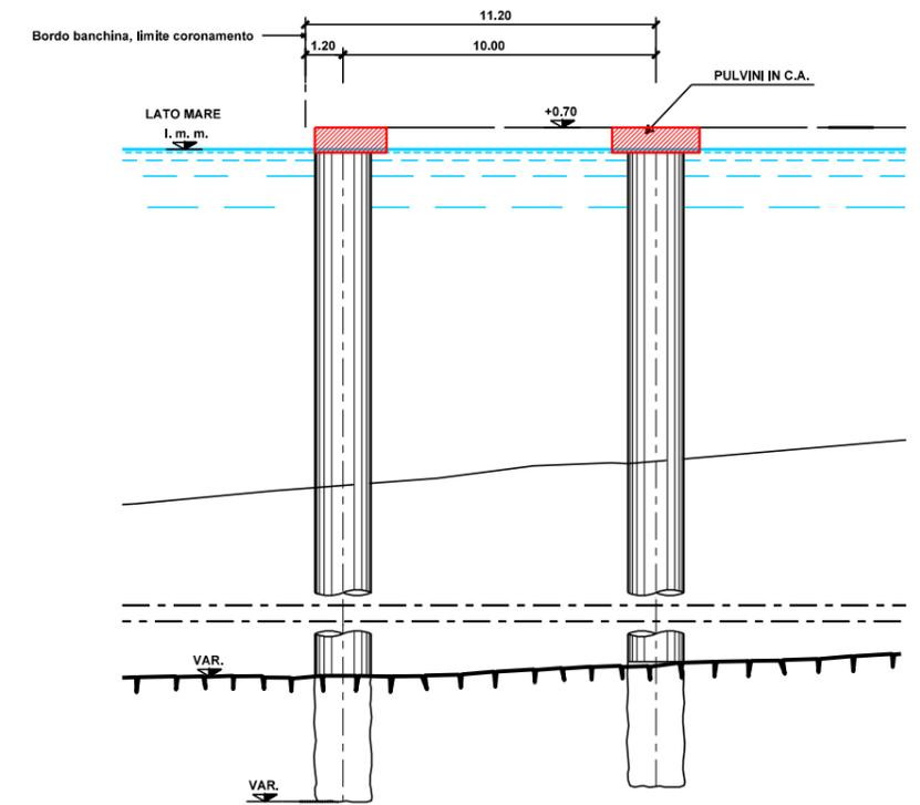
SEZIONE TIPO BANCHINA CON PALI IN C.A.
