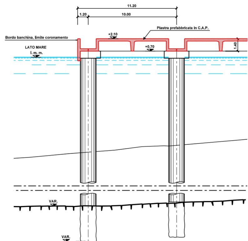
SEZIONE TIPO BANCHINA CON PALI IN C.A.
