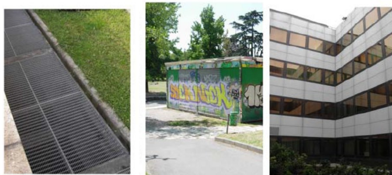
Figura 6 - Esempio di alcuni target la cui RCS è stata misurata da osservazioni satellitari in banda C (Perissin and Ferretti, 2007). La griglia di sinistra ha una RCS = 12000 \text{ m}^2 , l’edicola a destra di 16000 \text{ m}^2 , l’edificio a destra di 54000 \text{ m}^2
