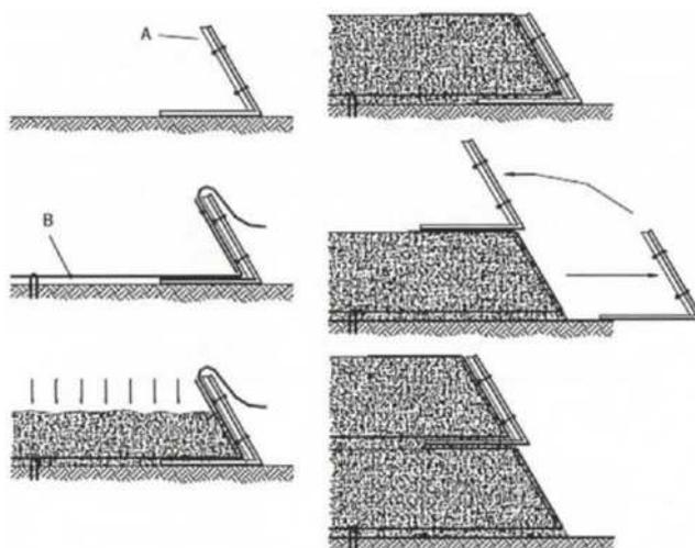
Figura 9 - Procedura di costruzione con geosintetici risvoltati alla facciata e casseri sfilabili: a) cassero sfilabile in tavole di legno e barre d'acciaio a L; b) geosintetico di rinforzo (da documentazione Officine Maccaferri Spa) - documentazione Officine Maccaferri Spa)
