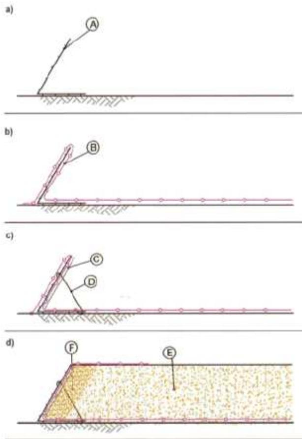
Figura 10 - Procedura costruttiva con casseri a perdere in rete elettrosaldata: a) posa del cassero in rete elettrosaldata (A); b) posa del geo sintetico di rinforzo (B), con la porzione corrispondente al risvolto all'esterno del cassero; c) posa della biostucco (C) e dei tiranti (D); d) stesa e compattazione del terreno (E), stesa di 200-300 mm di terreno vegetale a ridosso della facciata (F), risvolto del geo sintetico di rinforzo
