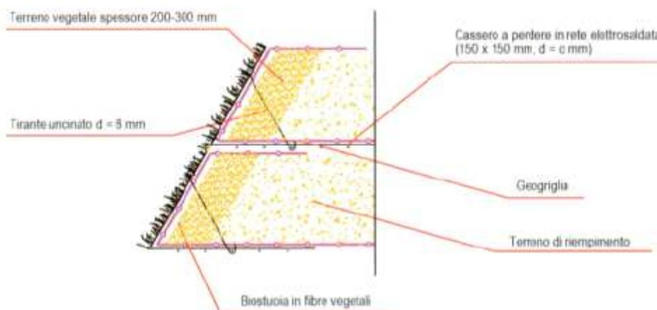
Figura 11 - Dettaglio della facciata con casseri a perdere in rete elettrosaldata
