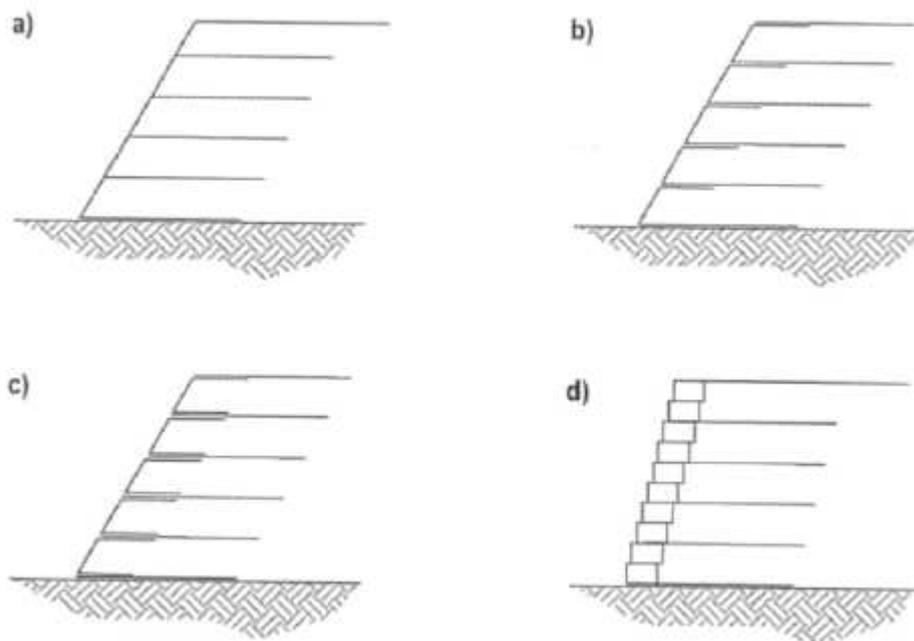
Figura 8 -- Schemi costruttivi per opere in terra rinforzata a facciata rinverdita: a) rinforzo lineare senza risvoltato; b) rinforzo risvoltato in facciata; c) schema misto: GSX di rinforzo lineare e altro GSX posto a C in facciata; d) rinforzi lineari e blocchi di facciata (da Recalcati e Rimoldi, 2001)
