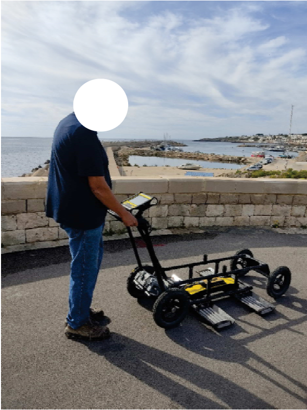
Fasi di lavoro misure radar con strumentazione "Noggin 100 con frequenza di 100 MHz" della "Sensors & Software inc."
