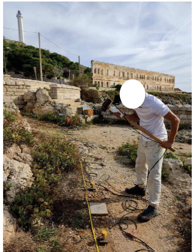
Energizzazione con mazza battente onde longitudinali (Onde P)
