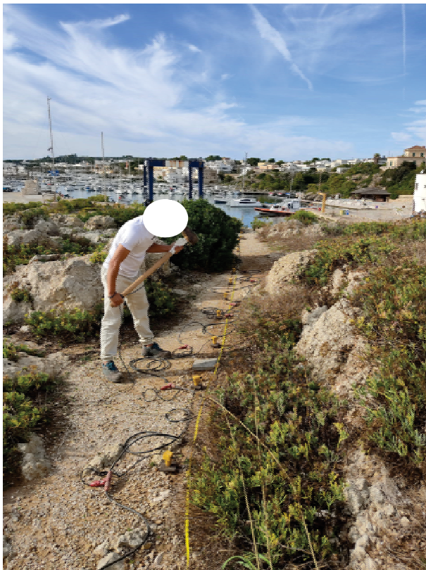
Energizzazione con mazza battente onde longitudinali (MASW)
