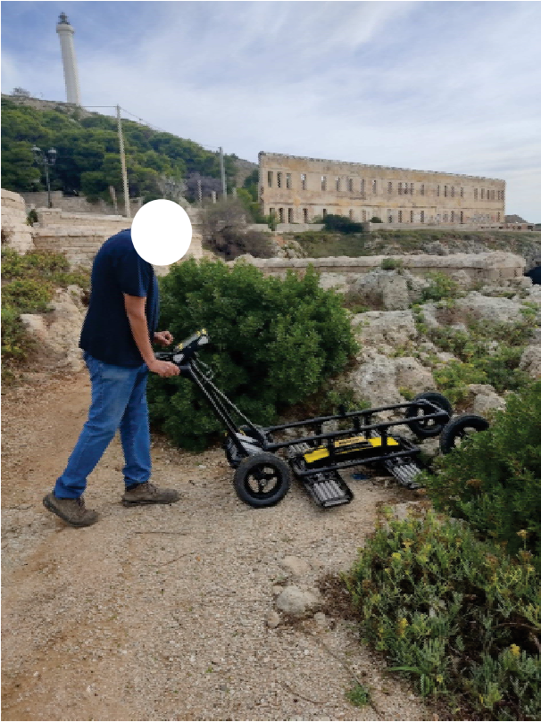
Fasi di lavoro misure radar con strumentazione "Noggin 100 con frequenza di 100 MHz" della "Sensors & Software inc."
