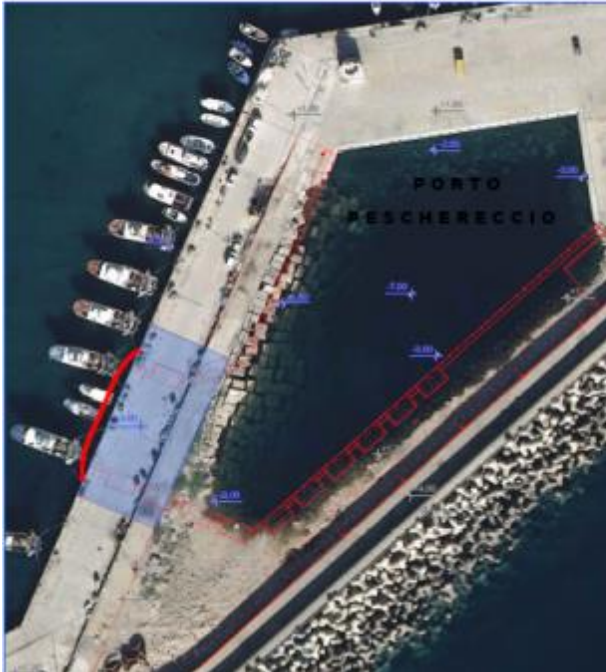
Fase Terza: Taglio del varco e realizzazione del Sarchinamento
