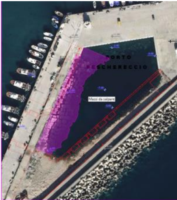
Fase Terza: Taglio del varco e realizzazione del Sarchinamento
