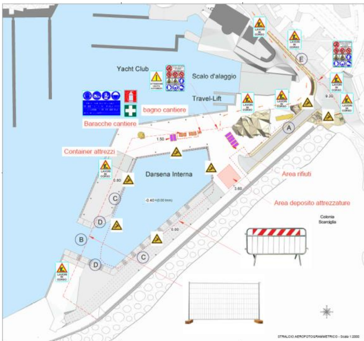
Figura 60: Layout di cantiere (Elaborato E407D_SC-03 di progetto)
