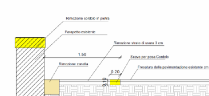
Figura 64: Particolare interventi di demolizione su via Doppia Croce
