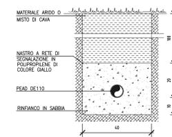
N.B.: Nel caso in cui il ricoprimento sia minore di 1 m, il tubo viene rinfiancato in cls.
