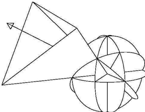
Il tracciamento delle piramidi viene proseguito fino ad ordini elevatissimi (anche se è possibile limitarlo ad un ordine prefissato), in modo da ricostruire l'intera coda sonora, in ciascun punto ricevitore.
