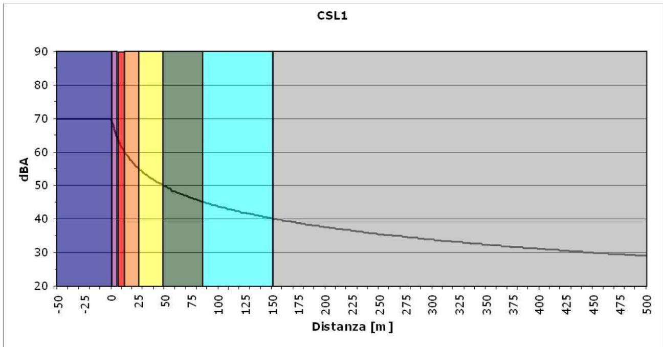
Proprio questa curva di decadimento sopra riportata individua le aree di potenziale interferenza; si osserva che nessun ricevitore che rientra nelle fasce di interferenza del cantiere è interessato dal superamento del limite di zonizzazione. Infatti tutti i ricevitori all'interno delle fasce hanno limite diurno pari a 70 dBA e le fasce comportano un livello massimo pari a 50 dBA. La tabella seguente riporta la distanza dal centro del cantiere delle fasce indicate nel grafico.
