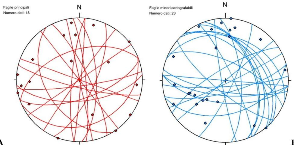
**Figura 5 – Set di faglie cartografabili osservate nella zona di Cravasco-Isoverde. A: faglie principali (con potenza delle rocce di faglia superiore a 100 cm); B: faglie minori (con rocce di faglia di spessore centimetrico-decimetrico). Proiezione equiareale di Schmidt, emisfero inferiore.**
