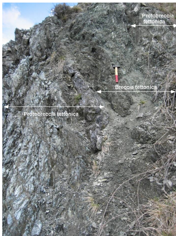
Figura 6 - Zona di deformazione cataclastica associata a una faglia di direzione circa N-S, cava di Pietra Cucco a N di Pietralavezzara.
