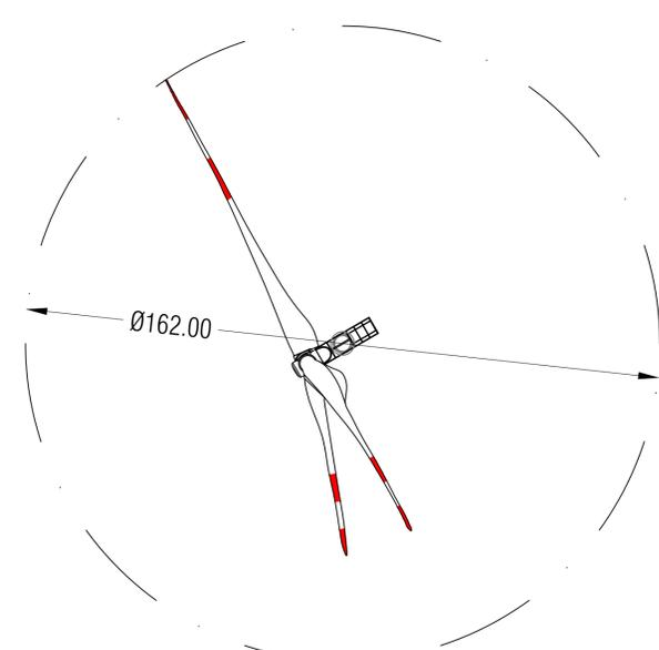
Nota: Le dimensioni riportate sono relative ad un modello generico di turbina di grande taglia. In base al modello di aerogeneratore selezionato in fase esecutiva, tali dimensioni potranno variare rispettando comunque l'altezza complessiva massima di 206.0 m (diametro del rotore, massimo 162 m; altezza al mozzo, massimo 125 m).
