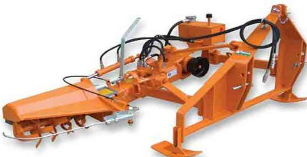
Figura 31 – Fresa interceppo per il controllo della fascia inerbita tra i sostegni dei moduli
