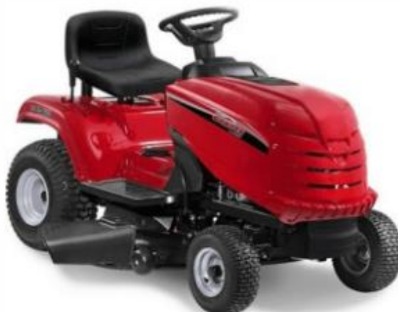
Figura 28 – Trattorino per la triturazione dell'erba sotto i pannelli
