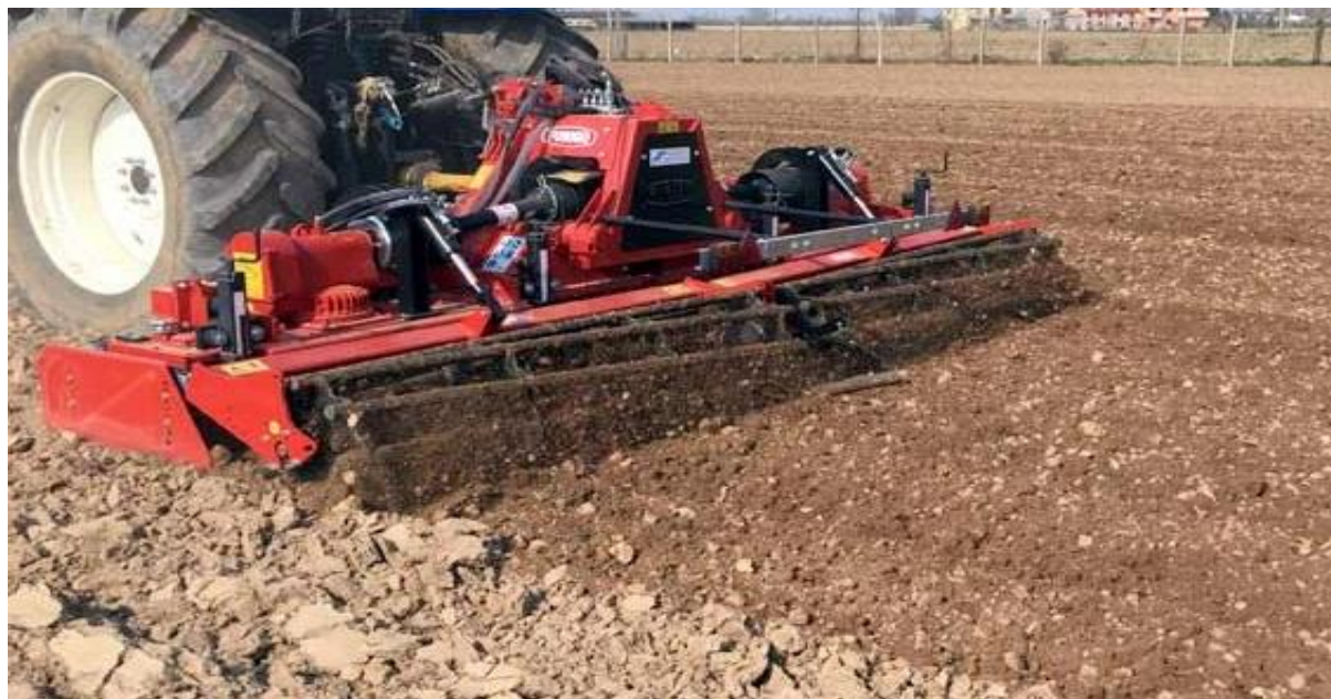
Figura 14 – Fresatura per l'affinamento del terreno
