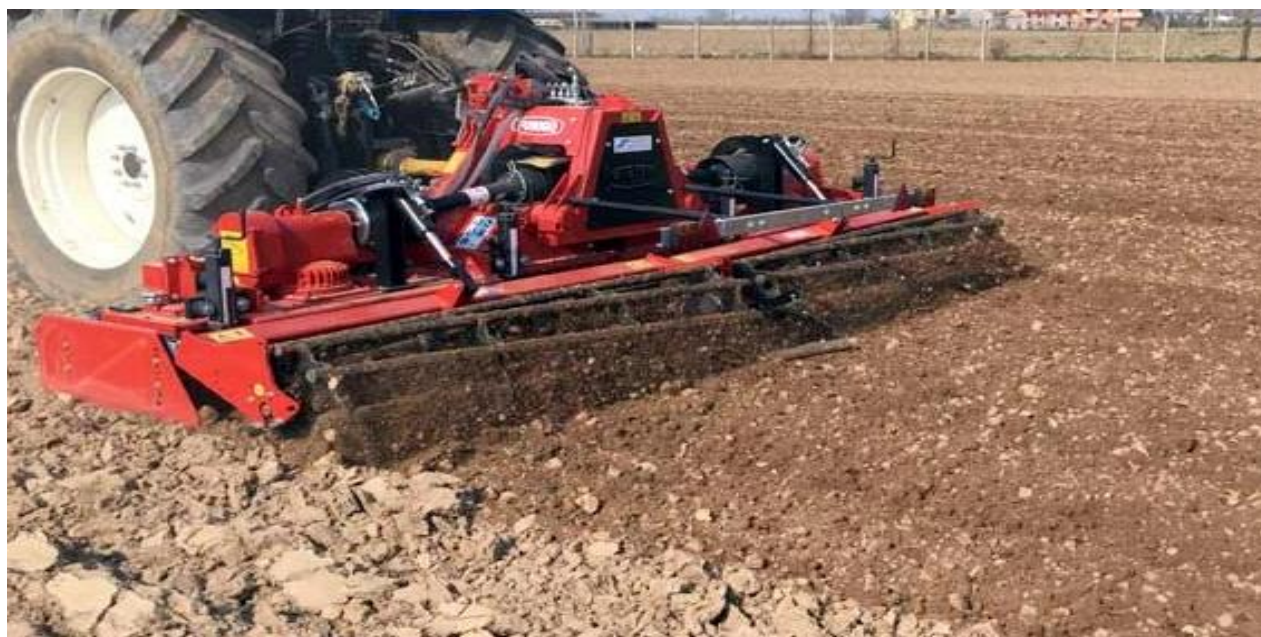
Figura 38 – Fresatura per l'affinamento del terreno
