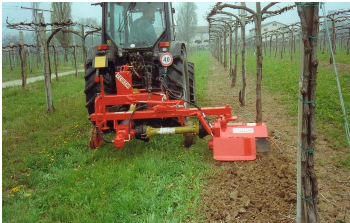
Figura 80 – Fresa interceppo per il controllo della fascia inerbita tra i sostegni dei moduli
