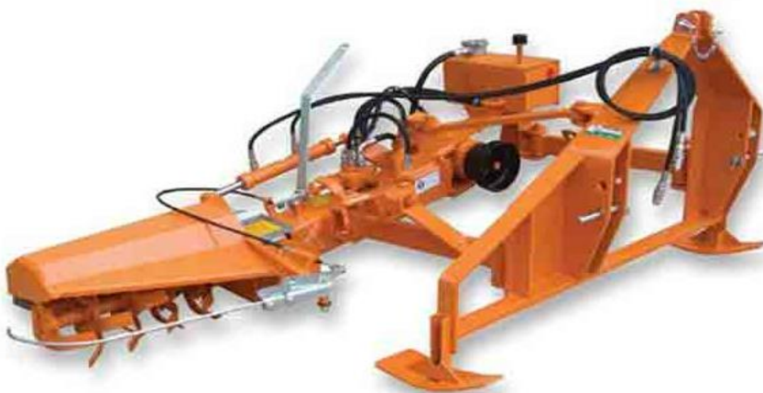
Figura 79 – Fresa interceppo per il controllo della fascia inerbita tra i sostegni dei moduli
