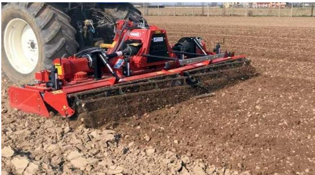
Figura 86 – Fresatura per l'affinamento del terreno
