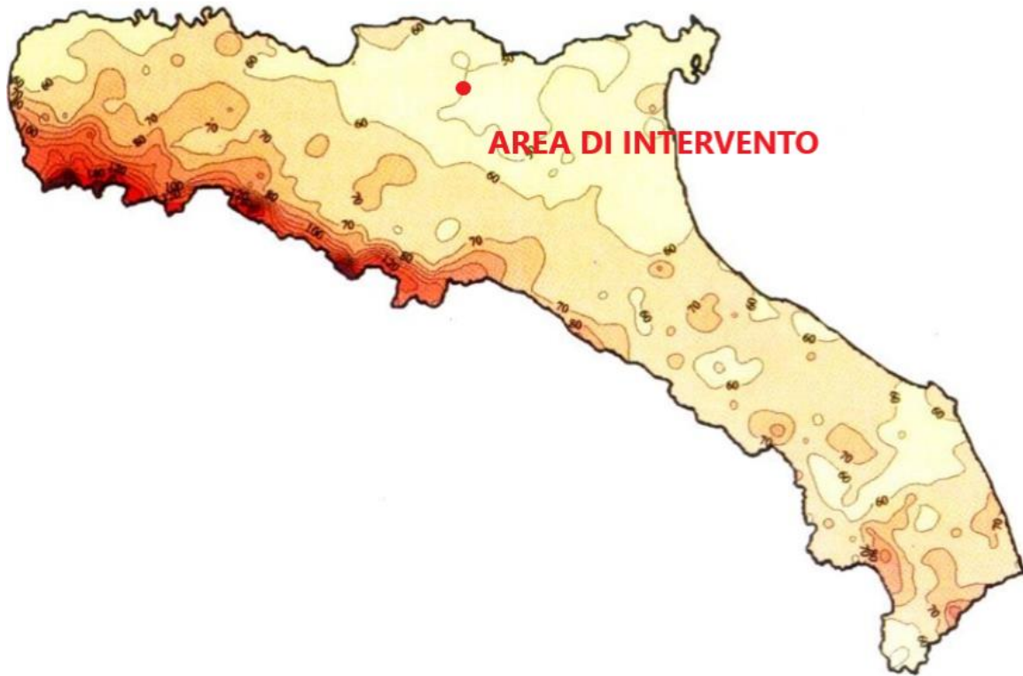
Figura 4-2- Iso linee delle altezze medie di pioggia massime annuali della durata di un giorno m(h_9)
