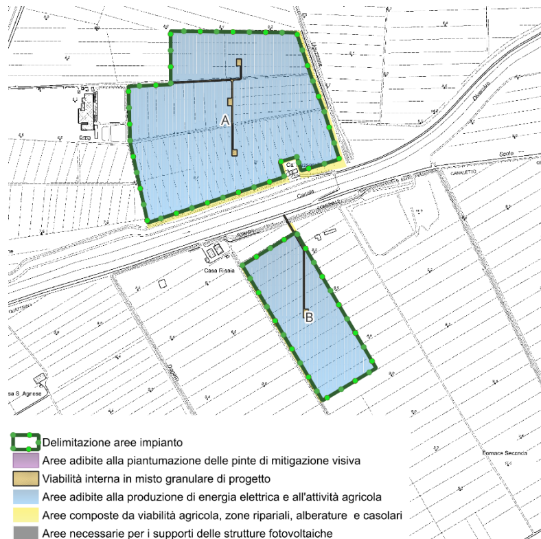
Figura 1-2- Suddivisione delle aree di impianto "Area nord"
