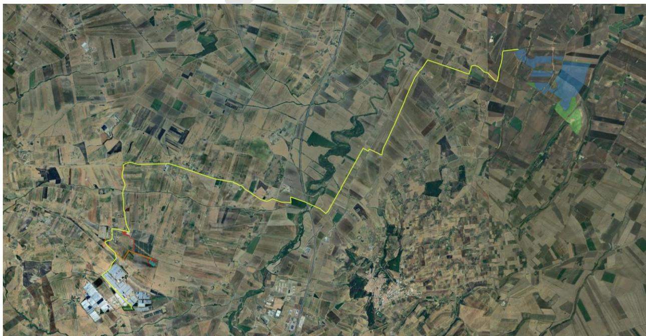
Figura 3-1: Localizzazione area di intervento, in blu la perimetrazione del sito, in giallo il tracciato della connessione in cavo interrata in Media Tensione e in rosso e arancio in Alta Tensione
