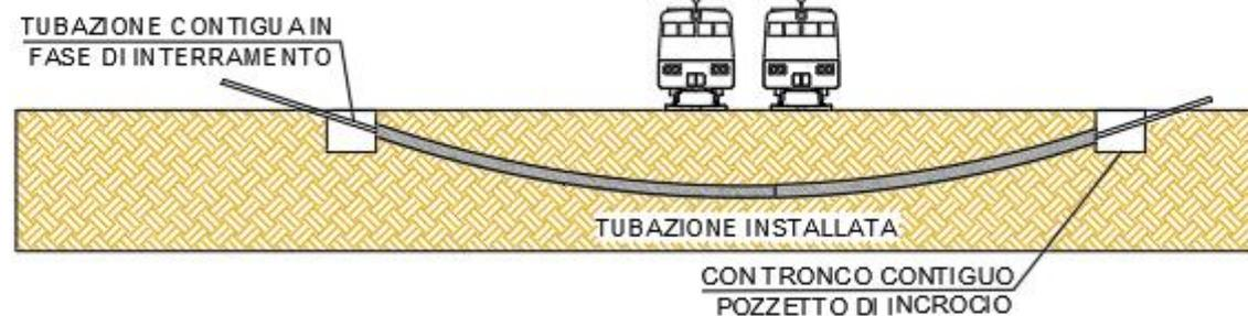
Figura 2-10: Modello sezione attraversamento in TOC
