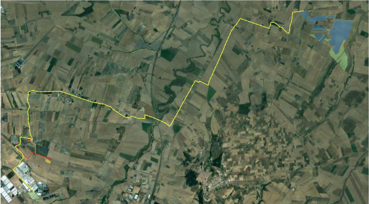
Figura 3-1: Localizzazione area di intervento, in blu la perimetrazione dell'aera d'impianto, in giallo e in rosso il tracciato dell'elettrodotto interrato MT e AT
