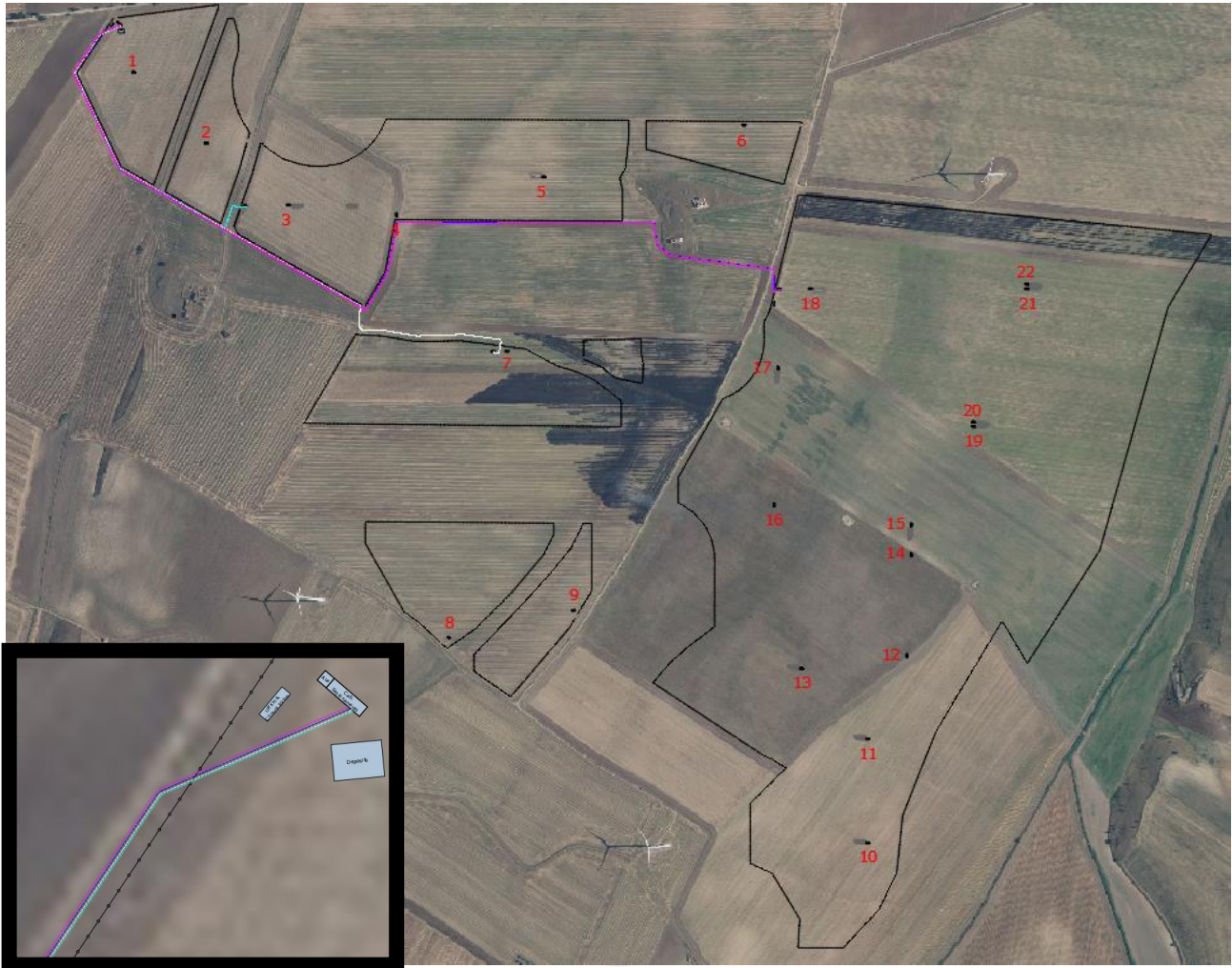
Planimetria dei circuiti interni di collegamento tra Delivery Station e Cabina di Sezionamento
