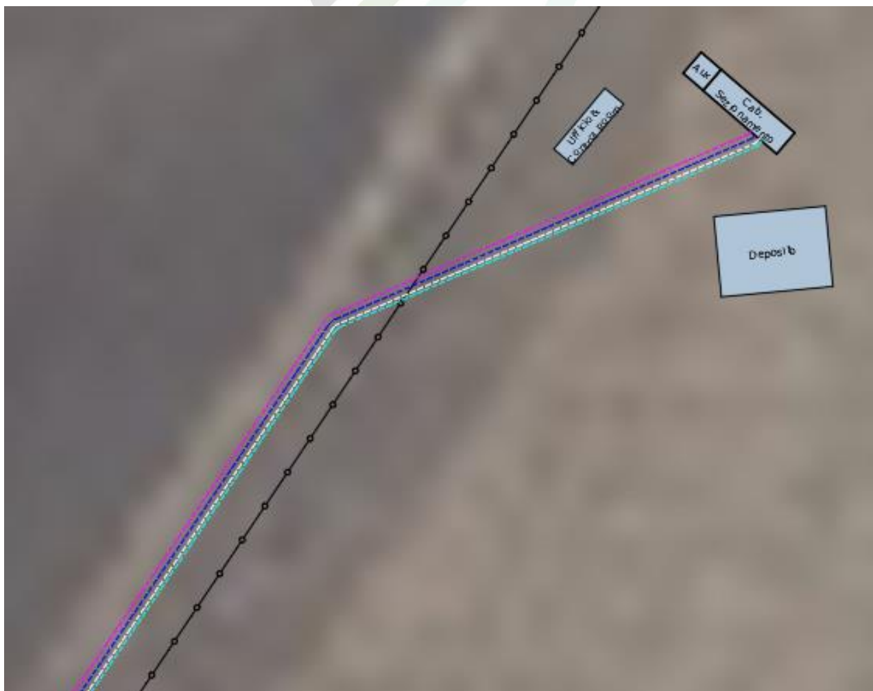
Particolare posa in avvicinamento alla Cabina di sezionamento
