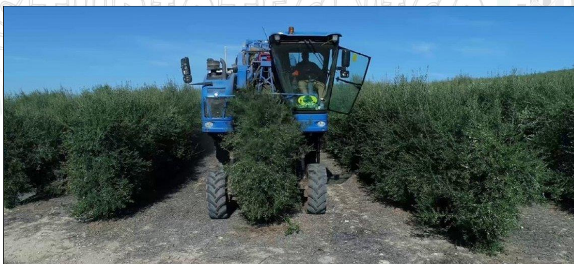
Figure 2 - Esempio di macchina scavallatrice durante la fase di raccolta
