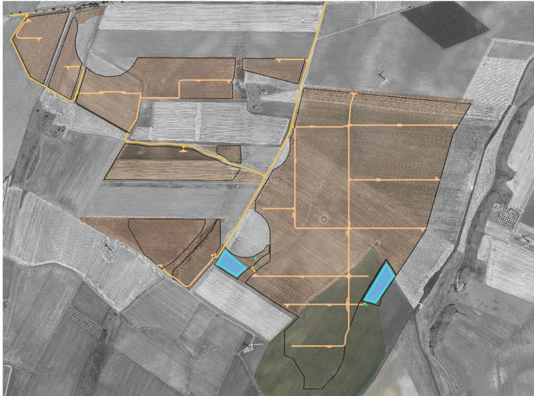
Il progetto prevede l'edificazione di n. 2 vasconi di raccolta acque alimentati ciascuno con un pozzo di estrazione. I vasconi hanno la capacità di circa 40.000mc (ovest) e 50.000 mc (est) con una profondità di circa 5m. L'ubicazione dei vasconi e dei pozzi non interferisce col naturale deflusso di acqua superficiali.
