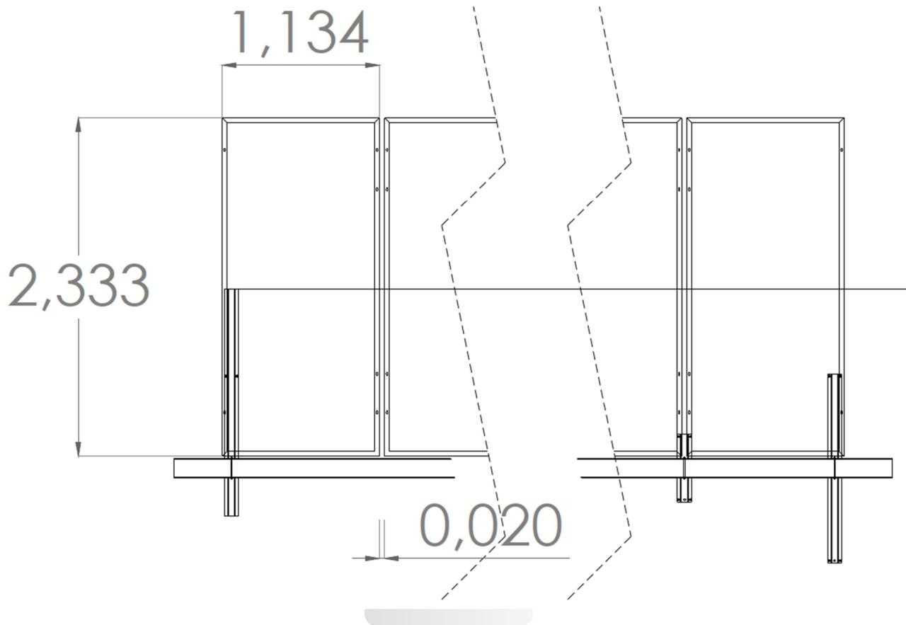
Figura 3-1: Dettaglio Modulo/Tracker
