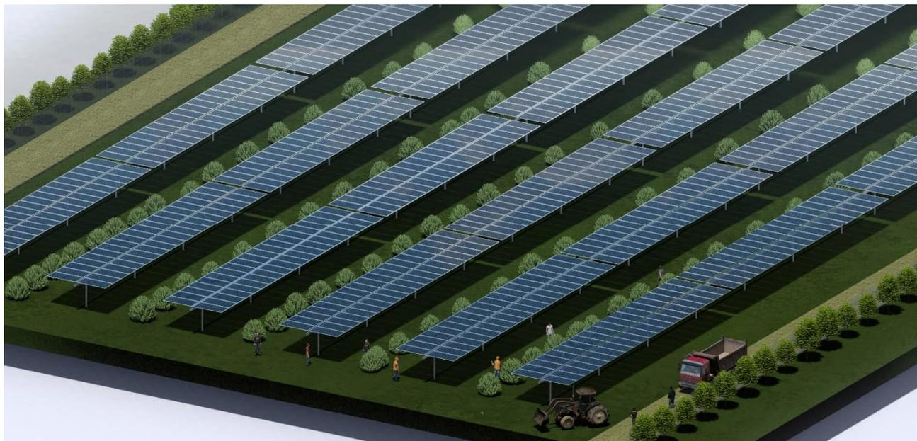
Figura 5-5: Schematizzazione dall'alto: albero – tracker – viabilità – recinzione – fascia perimetrale
