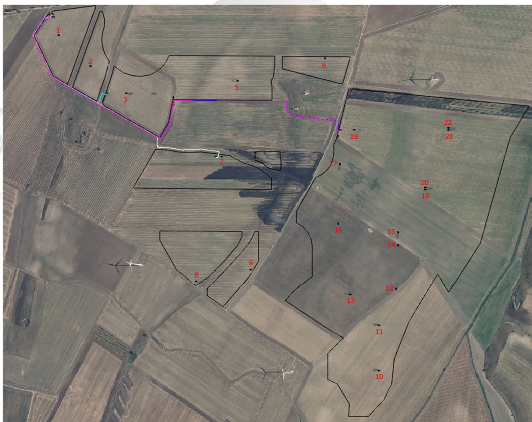
Fig. 3-2: Planimetria dei circuiti interni di collegamento tra Delivery Station e Cabina di Sezionamento
