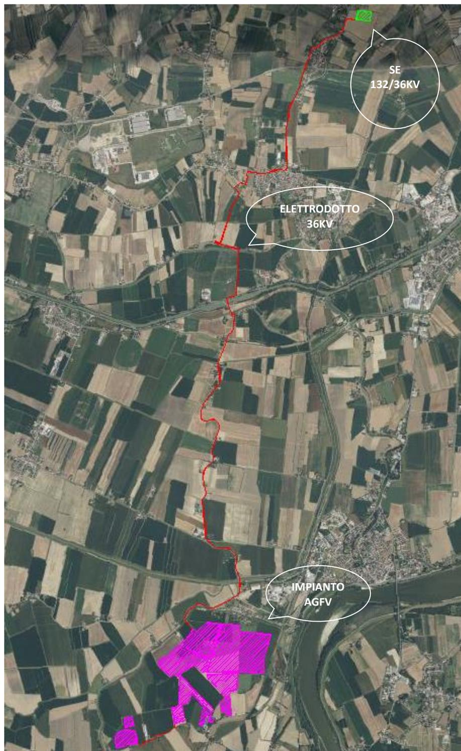
Figura 4-1 Layout impianto e connessione alla Stazione Elettrica
