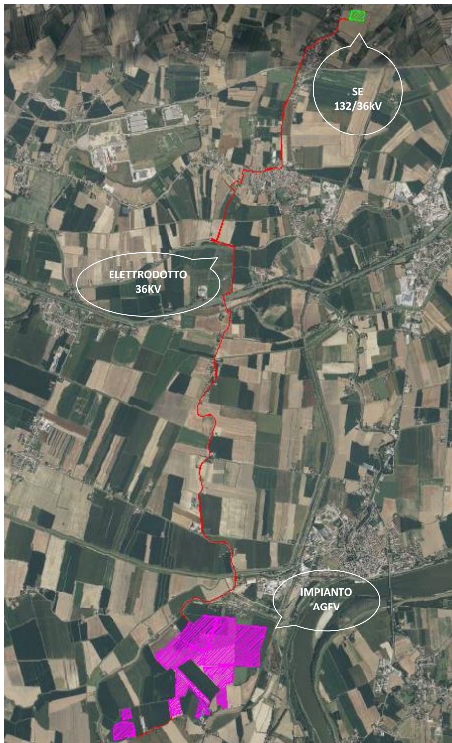
Figura 5-10. Layout impianto e connessione alla Stazione Elettrica
