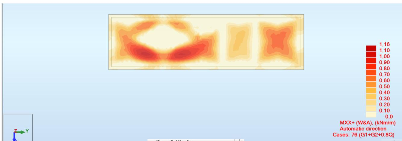
FIG. 65– INVILUPPO SUPERIORE MOMENTO FLETTENTE (WOOD&ARMER) DIREZIONE X
