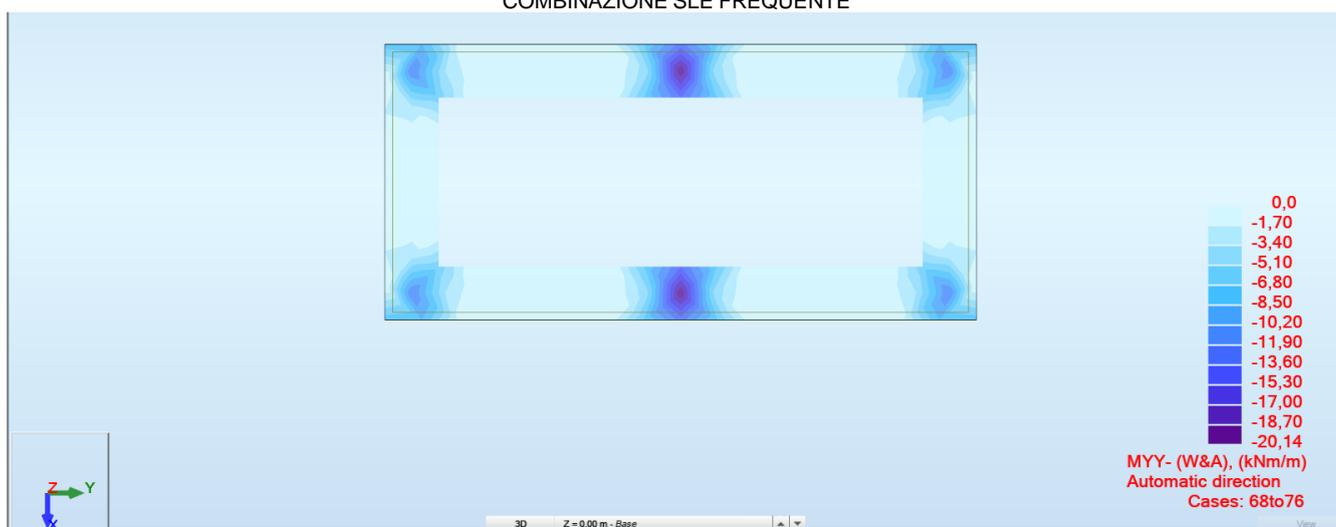
Fig. 80– Involuppo inferiore Momento Flettente (Wood&Armer) direzione y
