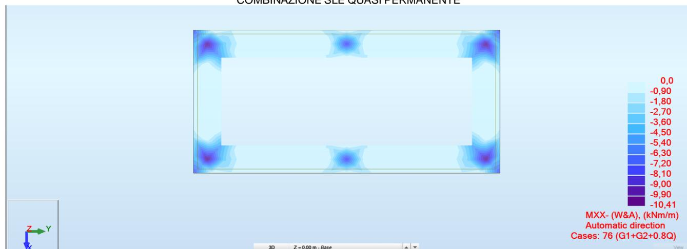
Fig. 74– Inviluppo inferiore Momento Flettente (Wood&Armer) direzione X
