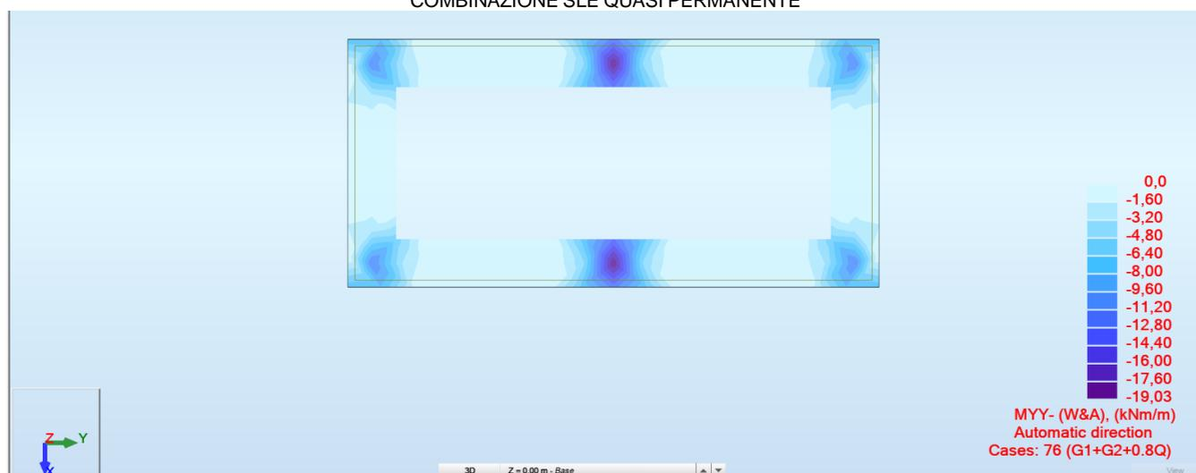
Fig. 76– Inviluppo inferiore Momento Flettente (Wood&Armer) direzione y
