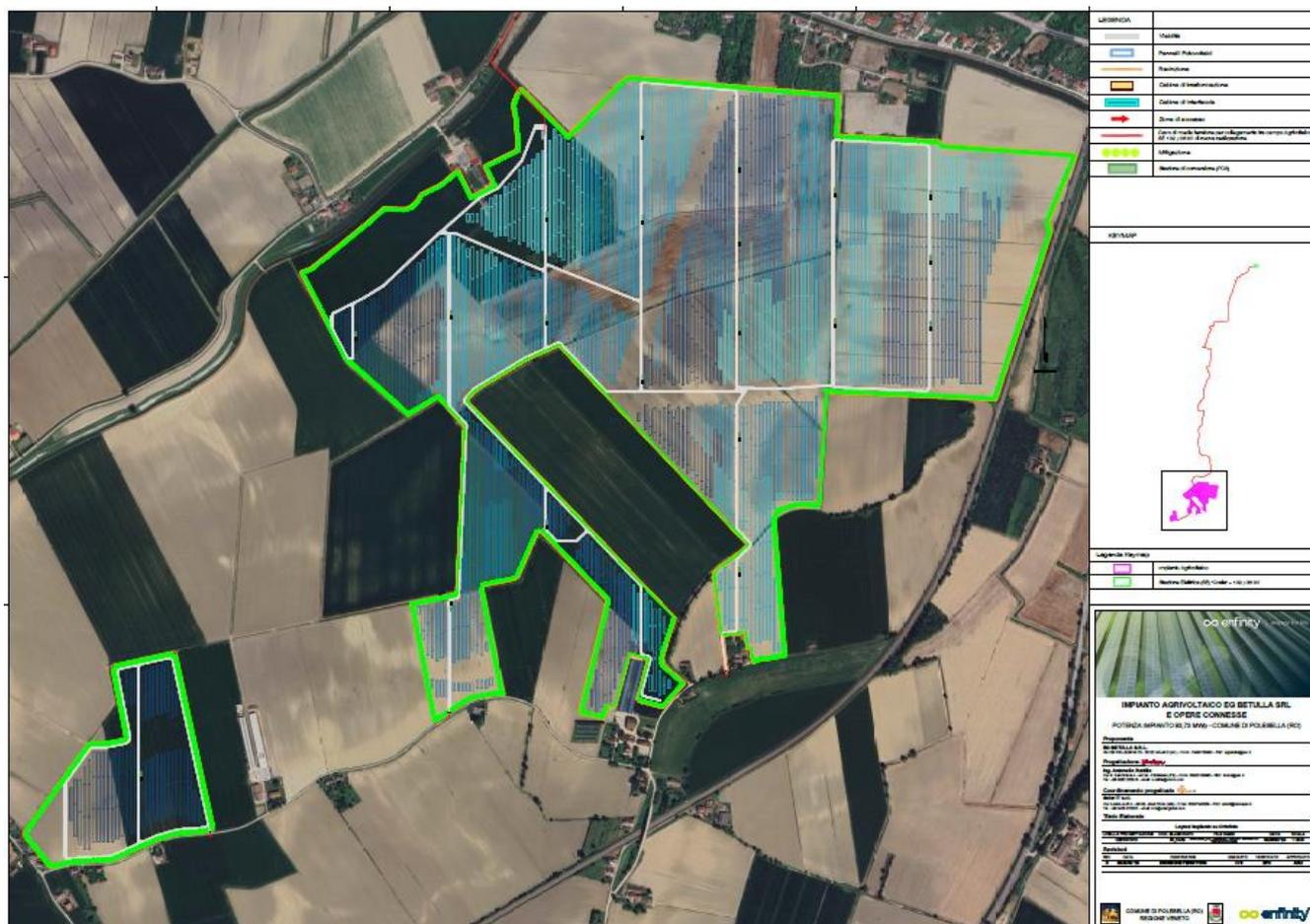
Figura 2 - Layout dell'impianto agrivoltaico su ortofoto
