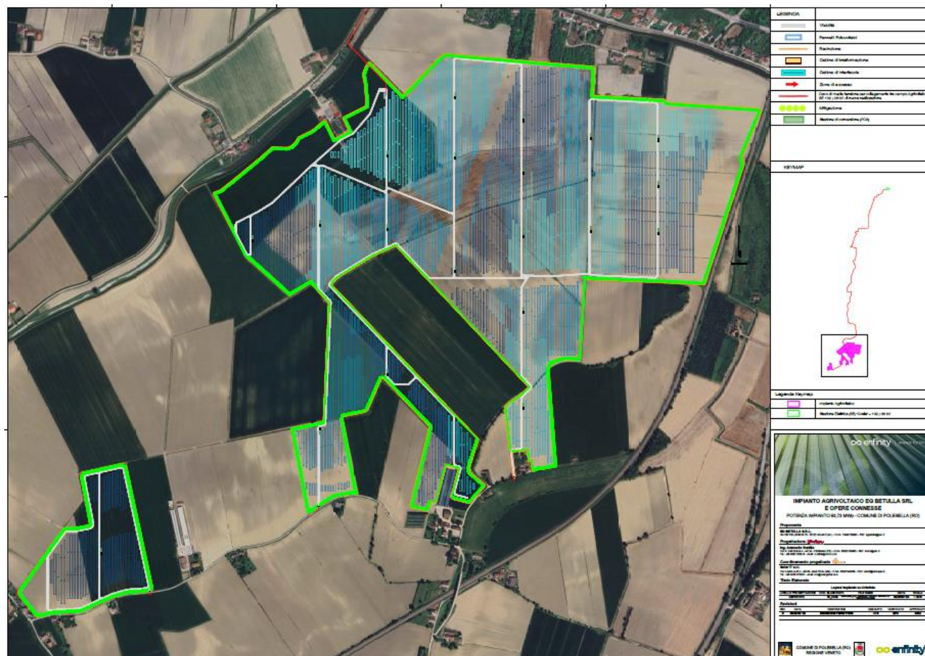
Figura 2- Layout dell'impianto agrivoltaico su ortofoto
