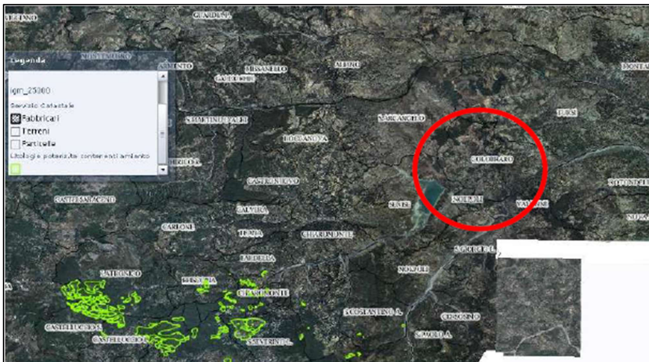
Figura 4.1.2: Regione Basilicata – Litologie potenzialmente contenenti amianto
