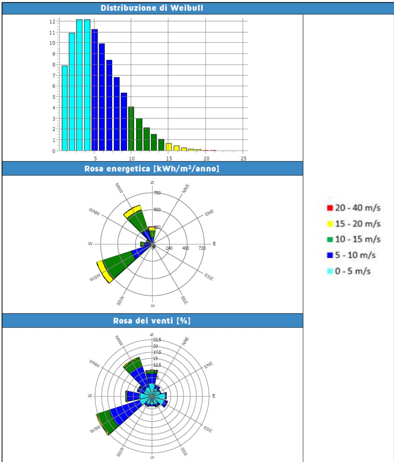
Figura 3.2: Parametri caratteristici Virtual Mast a 125 m
