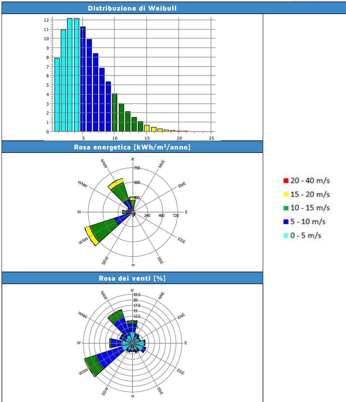
**Fig. 3 - Parametri caratteristici del Virtual Met Mast a 125 m**
