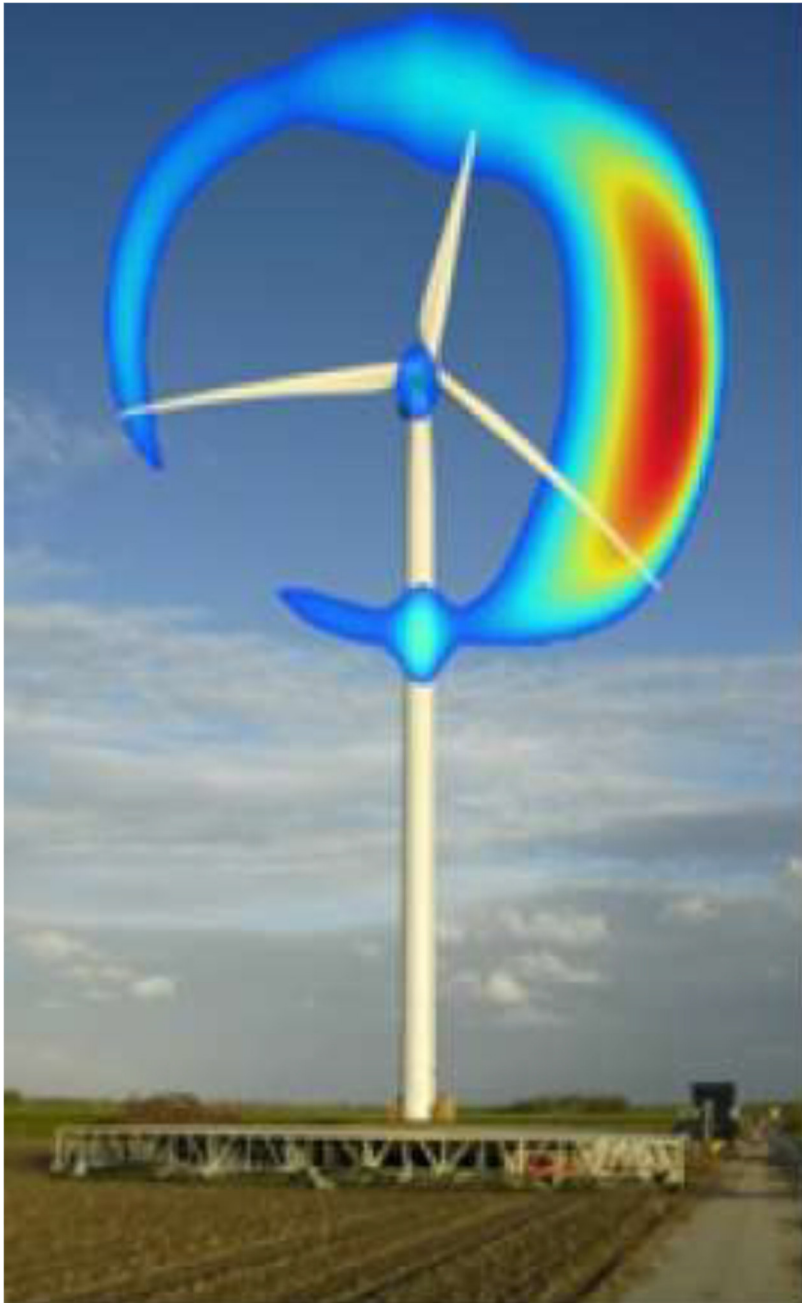
Rumore rilevato con SISTEMA BEAMFORMING
