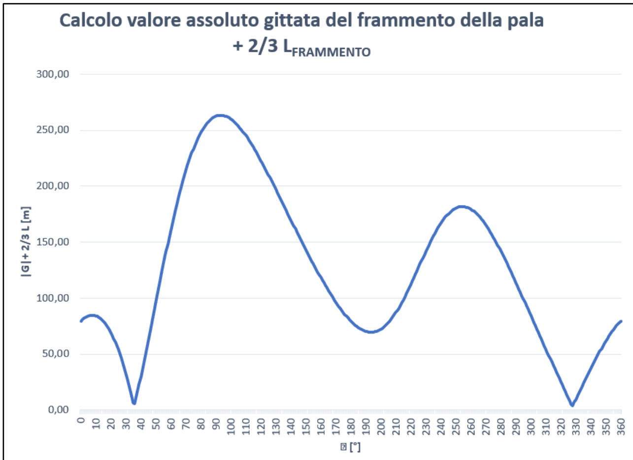
Figura 8.2: Grafico del valore assoluto della gittata del frammento della pala di lunghezza 5 \text{ m} + 2/3 L_{\text{FRAMMENTO}}
