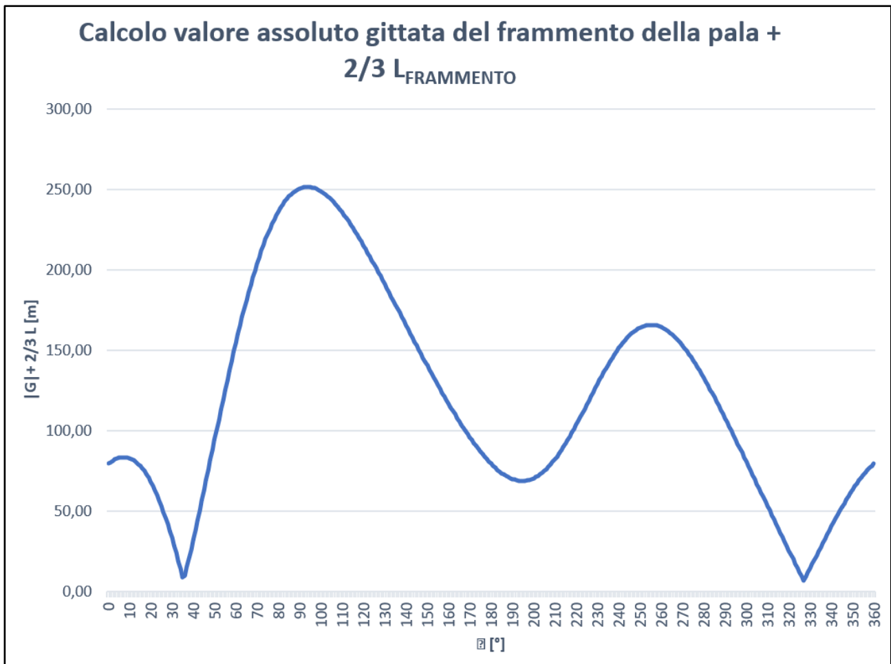
Figura 8.4: Grafico del valore assoluto della gittata del frammento della pala di lunghezza 10 \text{ m} + 2/3 L_{\text{FRAMMENTO}}
