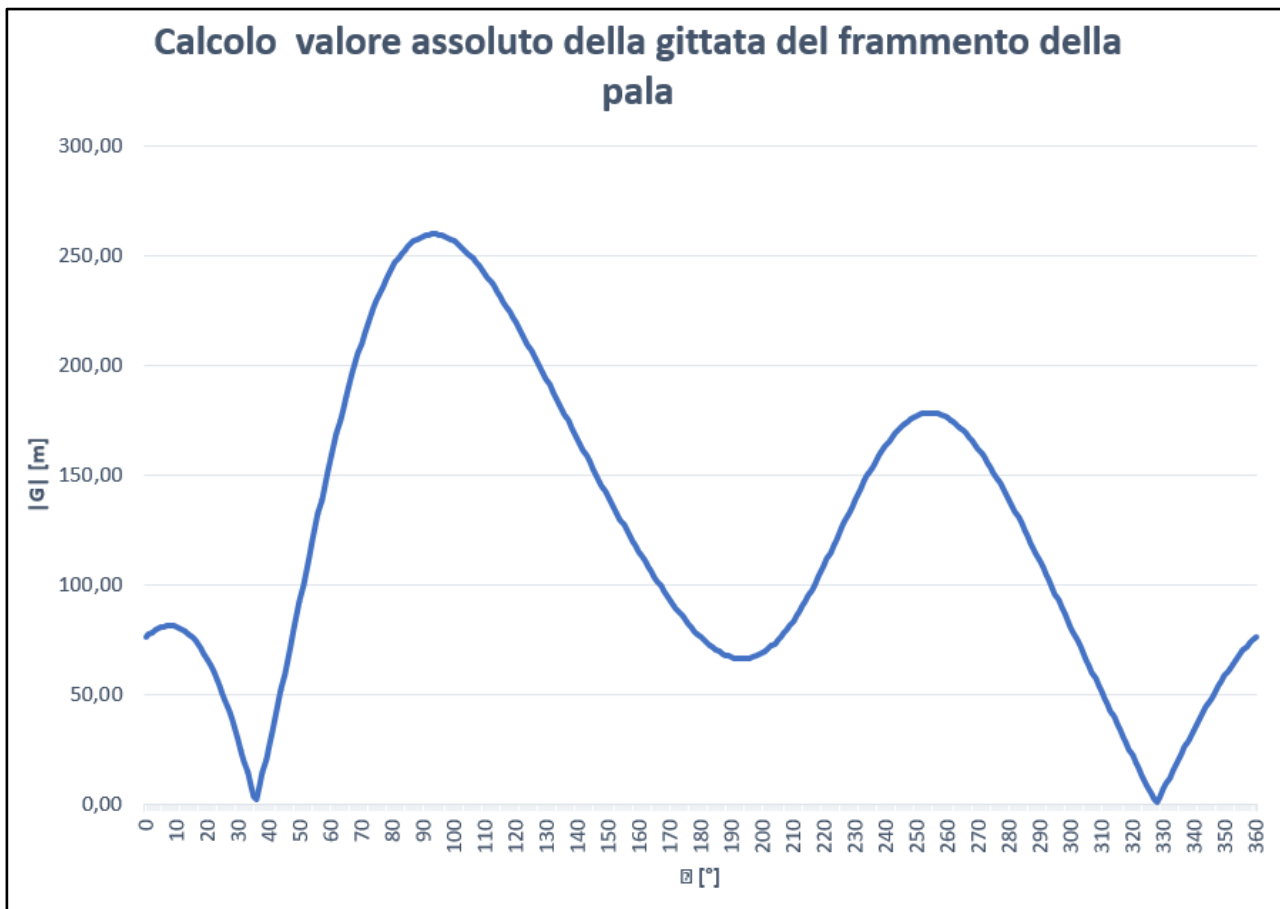
Figura 8.1: Grafico del valore assoluto della gittata del frammento della pala di lunghezza 5 m
