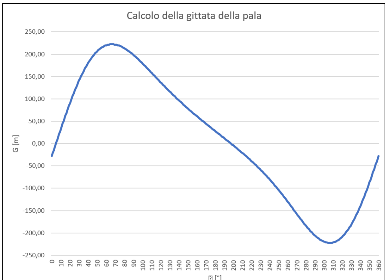
Figura 7.2: Rappresentazione grafica della gittata della pala
