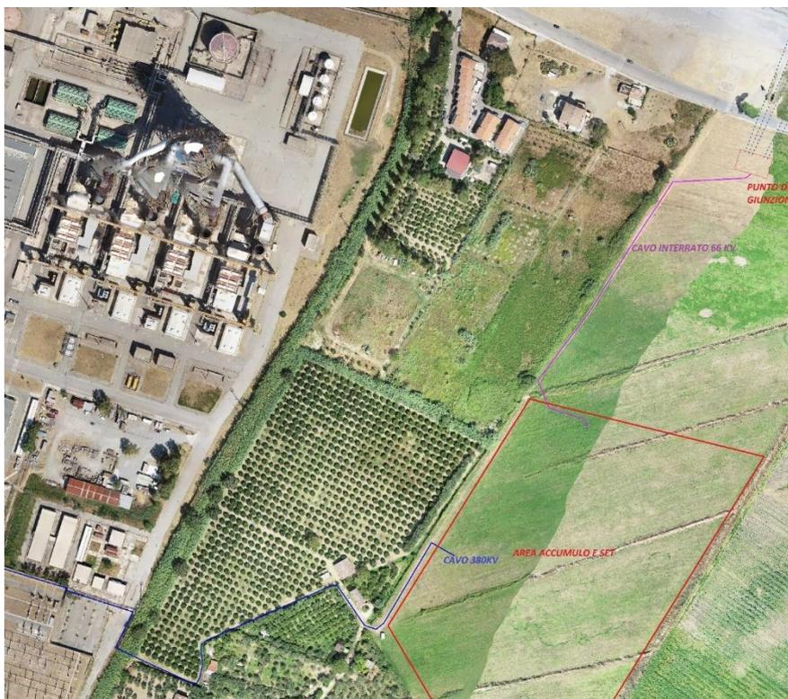
Figura 55: Ipotesi di percorso del cavidotto terrestre interrato.
