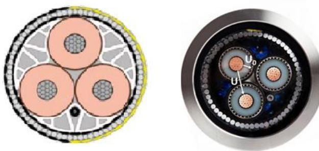
Figura 45: Sezione di cavo marino.
