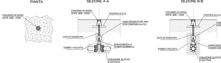
POZZETTO DI SCARICO PER ACQUEDOTTO
