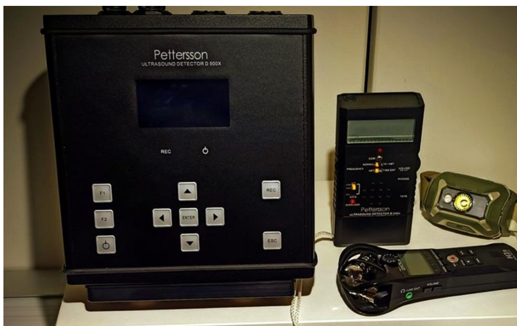
Foto 27 - Attrezzatura utilizzata per il monitoraggio dei chiroteri
