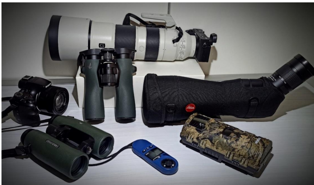
Foto 6 - Attrezzatura utilizzata per lo studio dell'avifauna. Binocolo Swarovsky EL 10X42 - NL PURE 10X42 e cannocchiale terrestre Leica APO Televid 82; per la misurazione dell'intensità del vento: Anemometro Kestrel 1000; GPS Garmin E TREX 100; Fotocamere Sony Alpha 6600 + tele 200/600 FE e Sony compatta. Fototrappola Wimius.
