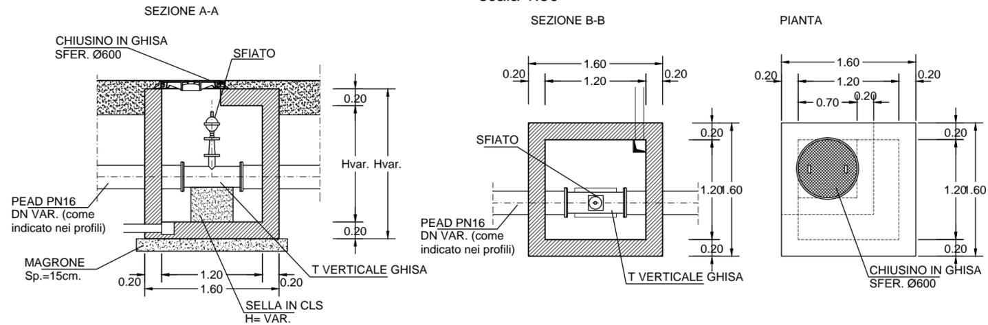
POZZETTO DI SCARICO - ACQUEDOTTO IN PEAD
