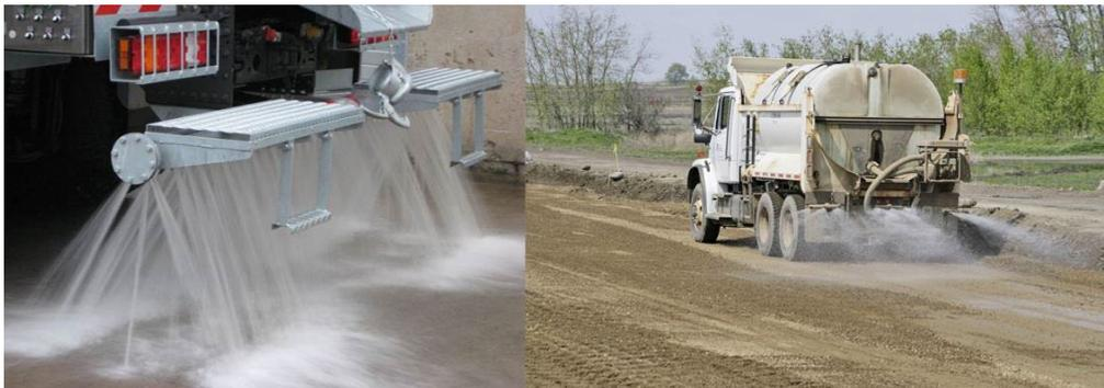
**Figura 26.** Automezzo per la bagnatura delle piste sterrate
