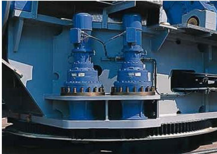
*Figura 10 -particolare idraulico di imbardata*
