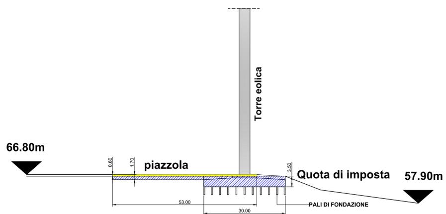
SEZIONE A-A' - STATO DI PROGETTO
