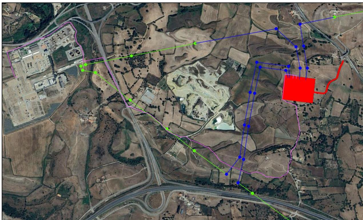
*Fig. 2 – Inquadramento delle opere di connessione alla rete. In rosso SE 150/36 kV "Codrongianos 36", in verdi linee aeree esistenti, in magenta nuovo cavidotto interrato a 150kV e in blu nuove linee aeree a 150 kV.*
