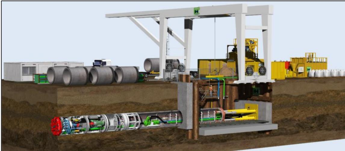
**Figura 4.20: Pozzo di lancio di un MT e stazione di spinta principale**
