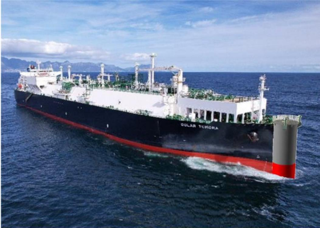
**Figura 4.33: FSRU con turret buoy**
