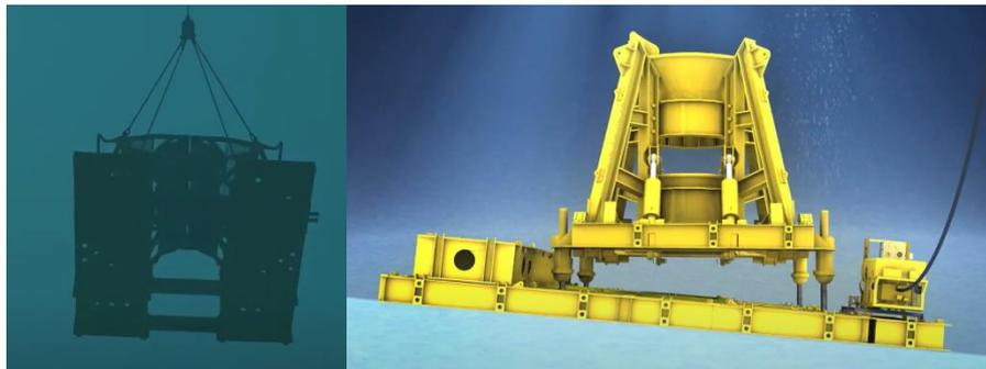
**Figura 4.35: Telaio guida**
