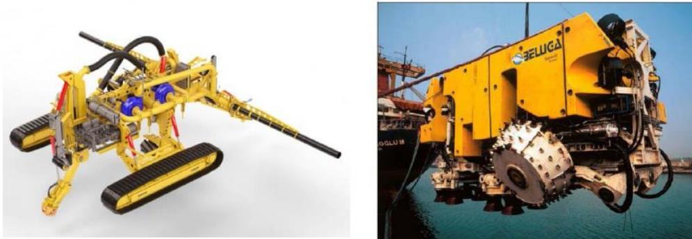
**Figura 4.14: Esempio di Mezzo Sottomarino Tradizionale per Operazione di Interramento della Condotta con Post trenching”**
