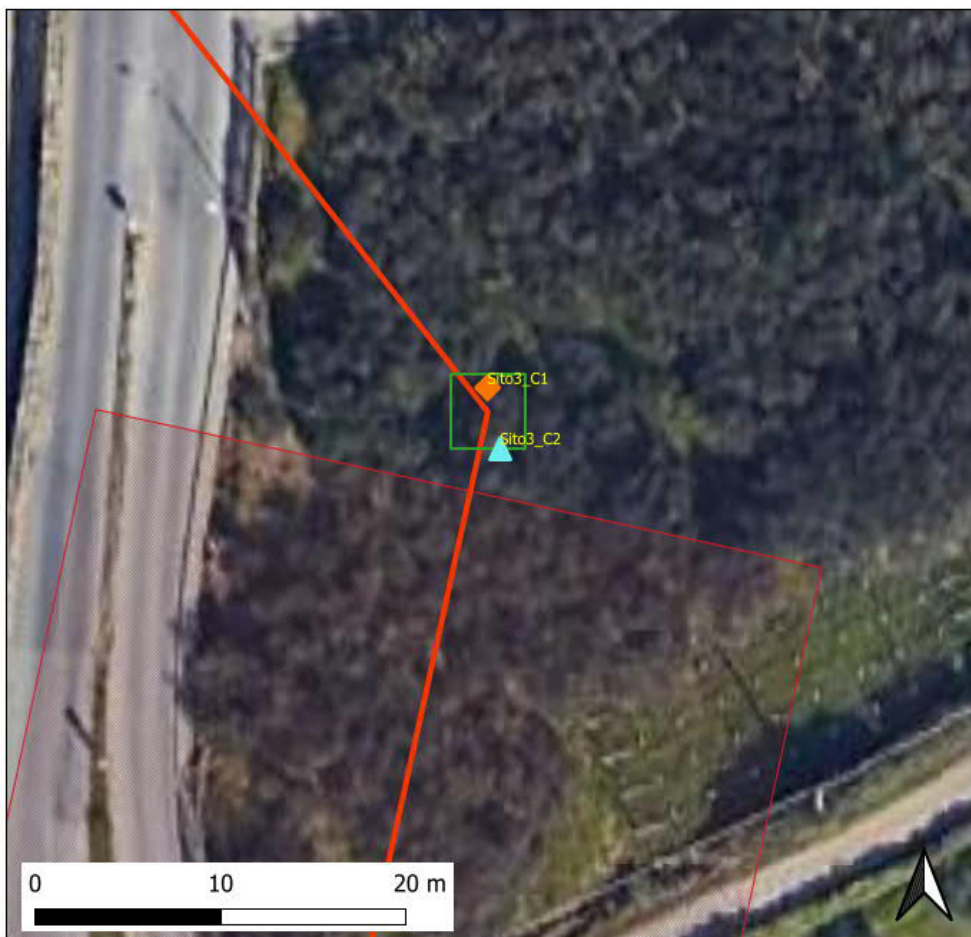
Fig. 7.C: Stralcio ortofoto con ubicazione punti di campionamento su fondo scavo (quadrato arancione) e su pareti di scavo (triangolo celeste).
