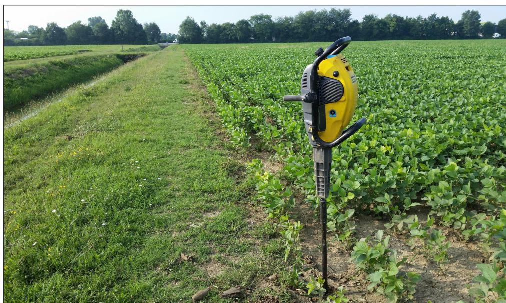
Fig. 7.2.B - Campionatore utilizzato per l'esecuzione del sondaggio ambientale per la caratterizzazione i terre e rocce da scavo
